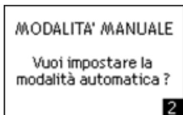
2. La seconda schermata compare esclusivamente se sull'unità è presente una sonda per il controllo automatico (sonda CO2, sonda VOC, sonda umidità, sonda portata costante o sonda pressione costante); l'unità è impostata in manuale:
