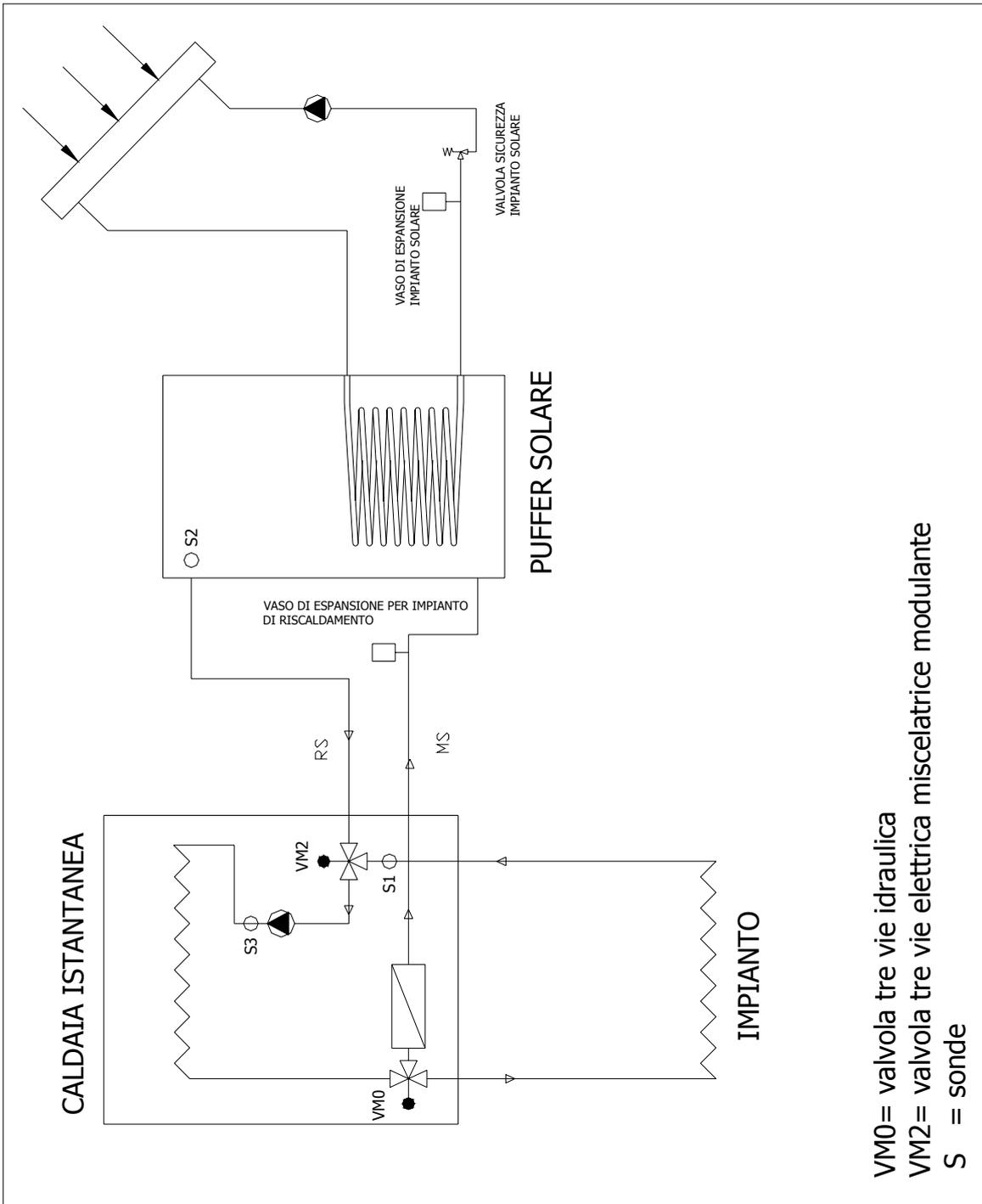
**N.B. Prevedere un termostato limite di blocco che agisca sull'alimentazione elettrica del circolatore solare nel caso in cui la mandata del solare superi i 105°C.**
