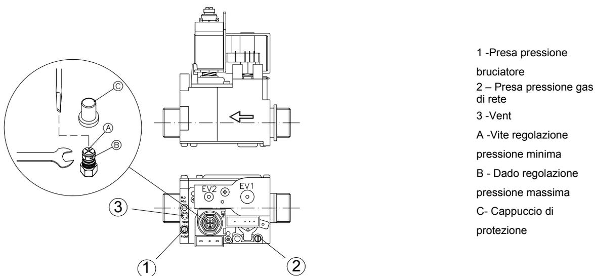
Per eseguire il controllo delle pressioni al bruciatore, inserire le sonde del manometro nelle prese di pressione disponibili sulla valvola gas (vedi fig.).
