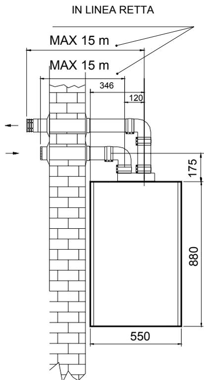
N.B.: La somma della lunghezza del tubo di scarico e quella del tubo di aspirazione non deve superare i 30 metri.
