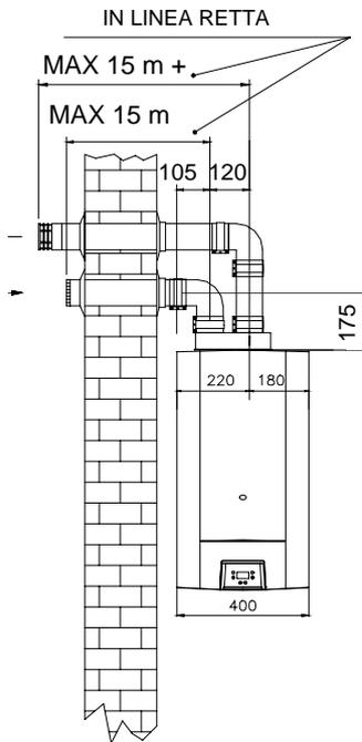
N.B.: La somma della lunghezza del tubo di scarico e quella del tubo di aspirazione non deve superare i 25 metri.
