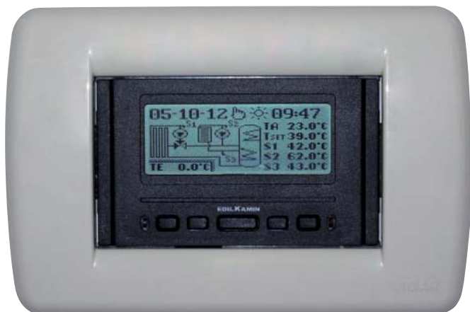
Ejemplo de display de instalación DOMOKLIMA integrado para la alimentación contemporánea de radiadores y paneles radiantes en combinación con paneles solares
