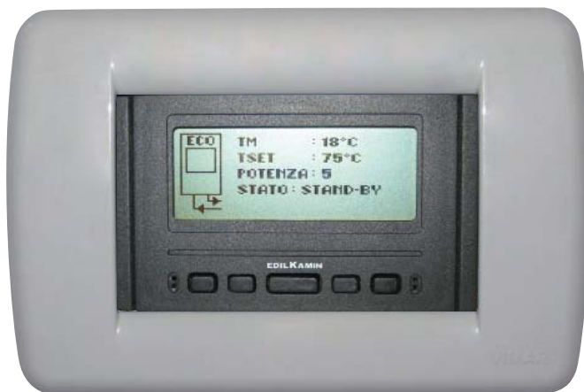
Esempio display di impianto con caldaia senza DOMOKLIMA
