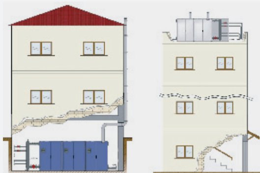
Esempio d'installazione di 3 Corolla 504 nella cantina di un'abitazione con collettore verticale di bilanciamento e condotto di uscita fumi Ø 160 mm in polipropilene.
