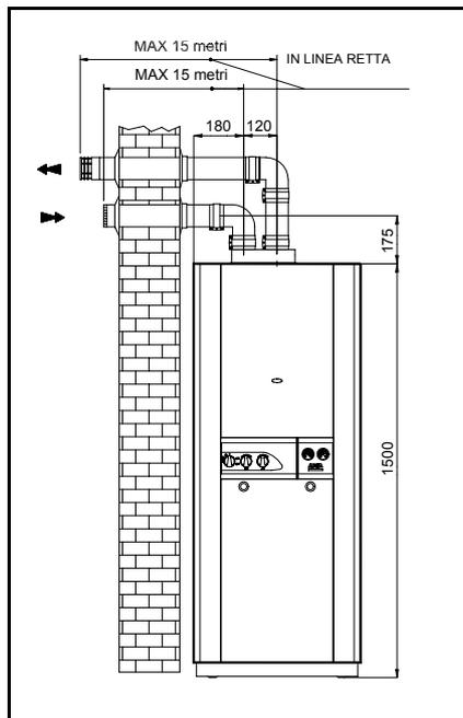
N.B.: La somma della lunghezza del tubo di scarico e quella del tubo di aspirazione non deve superare i 30 metri. Per ogni curva aggiunta la lunghezza massima consentita deve essere diminuita di 2 metri.
