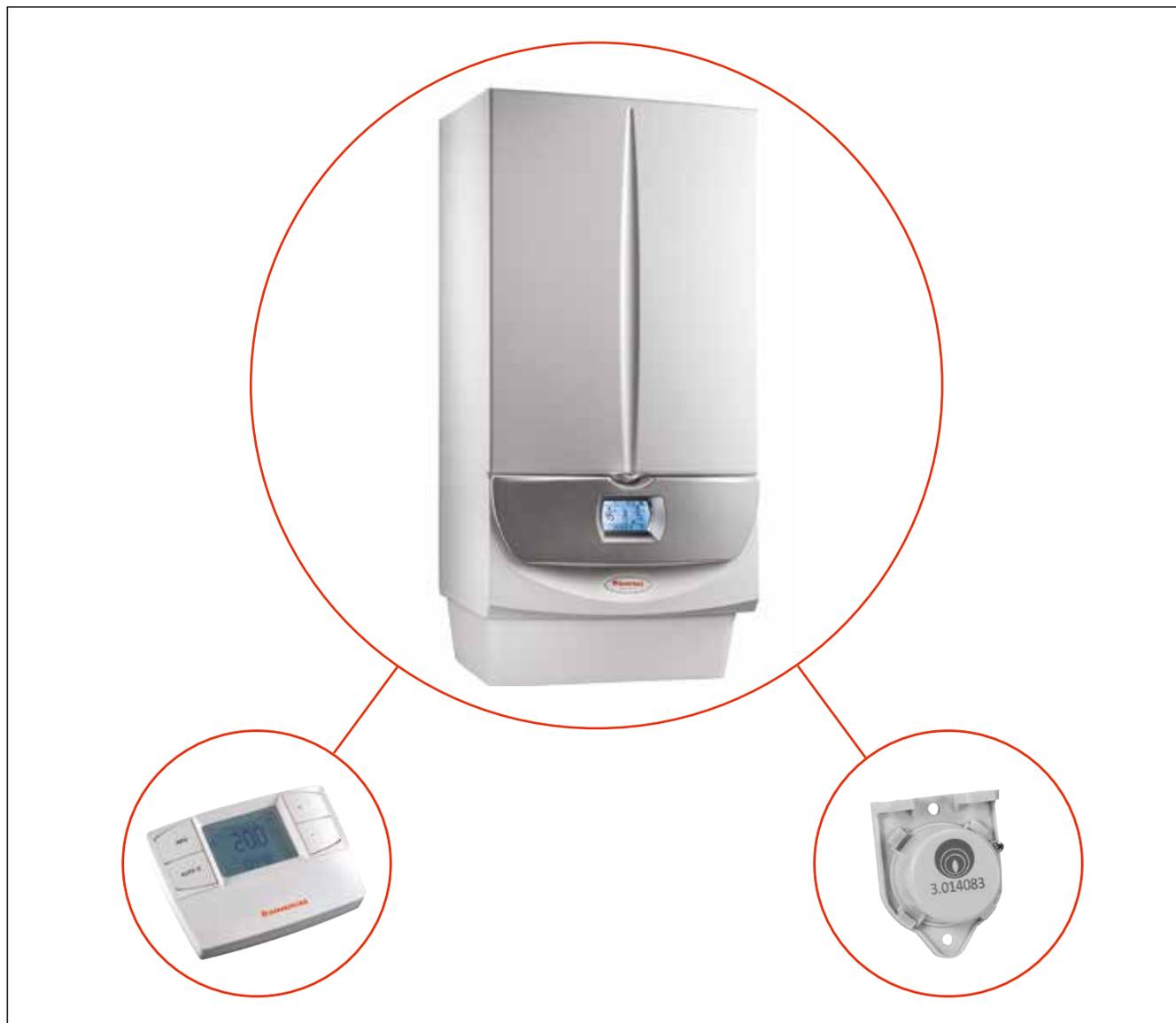
MAGIS VICTRIX ErP è un sistema costituito da caldaia a condensazione con potenzialità di 23,6 kW in riscaldamento e 26 kW in sanitario e gruppo idraulico di connessione e distribuzione predisposto per l'abbinamento a pompa di calore AUDAX monofase, ideale in nuovi appartamenti per realizzare sistemi integrati per riscaldamento, raffrescamento e produzione di acqua calda sanitaria, per soddisfare le prestazioni richieste dal D.Lgs. 28/2011 e s.m.i.
