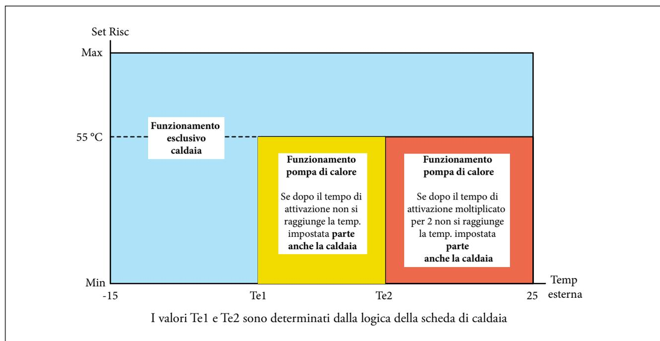
Attivazione caldaia = funzionamento in climatica, con sonda esterna;
