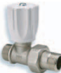
204 - Valvola per radiatori dritta. Per tubo rame. Filetto 1/2.
