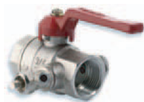
840/S - Valvola a sfera con spurgo, FxF. Leva in alluminio. Disponibile a richiesta con leva in acciaio plastificato o farfalla in alluminio.
