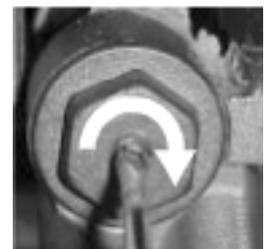
Fig. 37 Regolare la valvola di by-pass.
