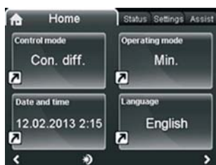
Fig. 11 Esempio del display principale di una pompa TPE serie 2000 con pannello di controllo avanzato
