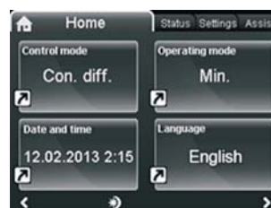
Fig. 1 Esempio del display principale di una pompa TPE serie 2000 con pannello di controllo avanzato
