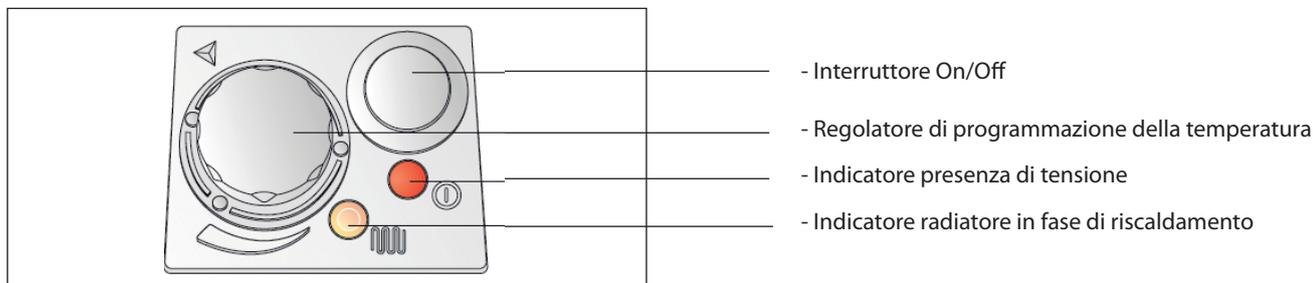
Tramite il regolatore è possibile programmare e/o modificare la temperatura ambiente. Il simbolo
