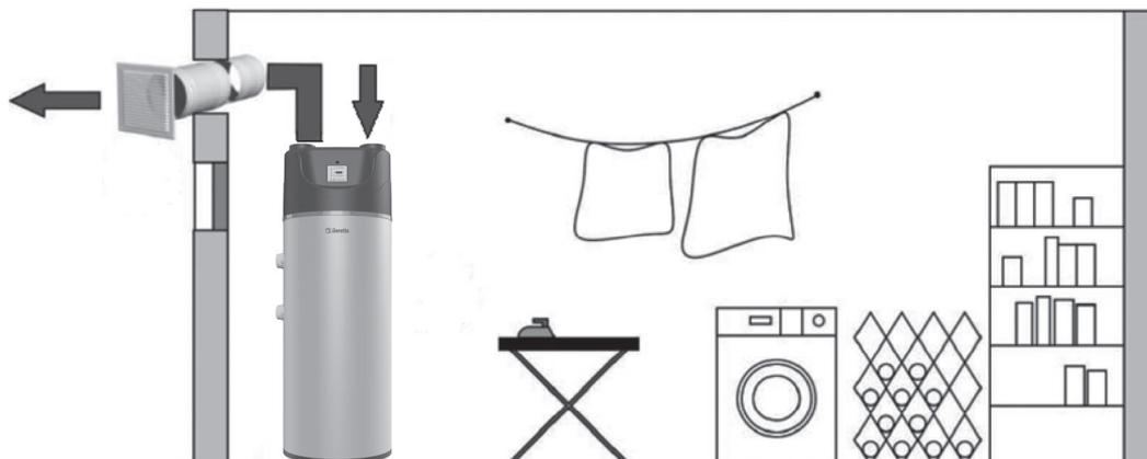
Qualora il locale di installazione sia particolarmente ristretto, è possibile canalizzare anche l'aspirazione prelevando l'aria da un locale tecnico adiacente. I canali non devono superare la lunghezza max totale (aspirazione e mandata) di 10 metri (tubo liscio con diametro non inferiore a 160 mm).
