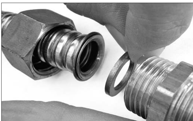
Inserire la guarnizione di rame tra estremità e raccordo
