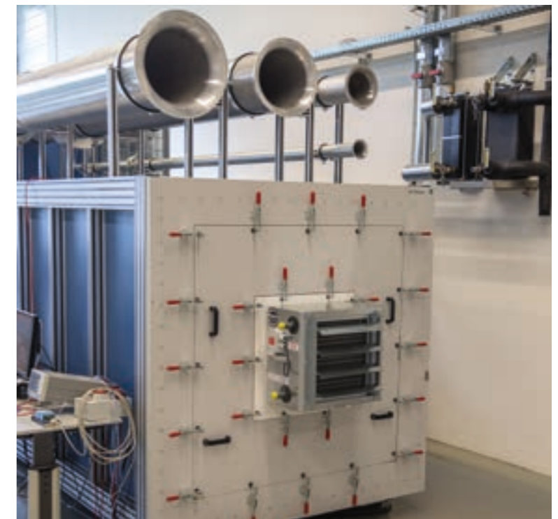
Banco di prova a cabina per le misurazioni della potenza d'aria sec. EN ISO 3745 (ex DIN 24163); Kampmann F&E Center
