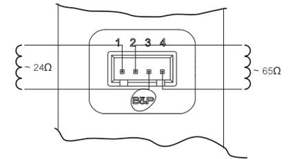
fig. 16 - Connessione valvola gas
