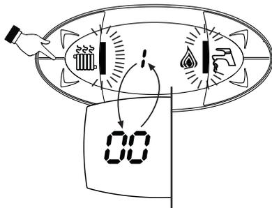
fig. 14 - Modalità TEST (potenza riscaldamento = 100%)
