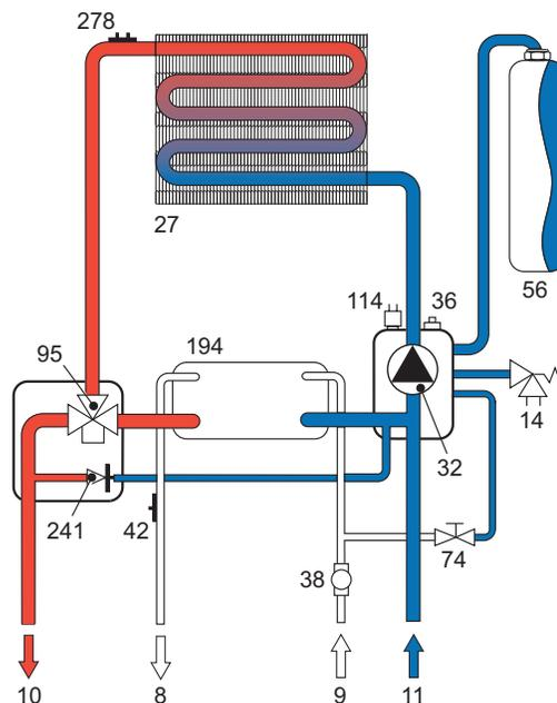
рис. 20 - Отопительный контур
