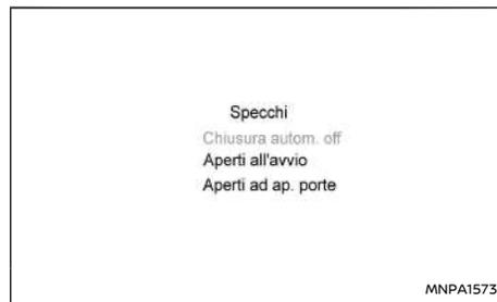
Gli specchietti esterni si aprono automaticamente quando l'interruttore di accensione viene girato sulla posizione ON o quando le porte del veicolo vengono sbloccate. Utilizzare il menu [Specchietti] del display delle informazioni veicolo per selezionare il momento in cui gli specchietti devono essere automaticamente ripiegati o aperti. La funzione di ripiegamento automatico può anche essere disattivata. Vedere [Impos. Veicolo] (pag.89).
