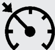
In caso di funzionamento improprio del sistema, viene emesso un segnale acustico e il colore dell'indicatore Cruise passa a giallo.
