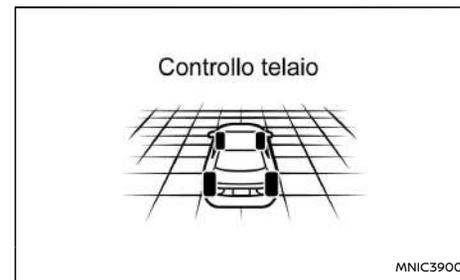
È possibile controllare lo stato di funzionamento del mantenimento automatico del freno nella modalità [Controllo chassis] sul display informativo multifunzione. Quando il sistema è attivo vengono evidenziate tutte e quattro le ruote.
