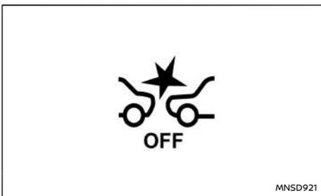
Quando il sistema IEB è disattivato, la spia di avvertimento del sistema IEB (gialla) si accenderà.
