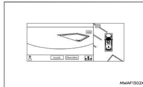
7. **Quando il veicolo entra nel rettangolo della posizione del cambio di direzione (verde), la posizione del cambio cambia automaticamente e il veicolo si muove in retromarcia.**
