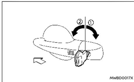
Per bloccare la porta del conducente, girare il cilindro della serratura della porta del conducente verso la parte posteriore del veicolo ①.
