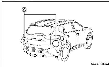
Il sistema BSW utilizza sensori radar (A) montati vicino al paraurto posteriore per rilevare altri veicoli che viaggiano in corsie adiacenti.
