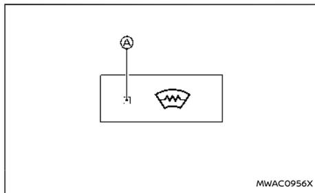
Il pulsante parabrezza riscaldato è situato sul pannello di controllo del climatizzatore anteriore.
