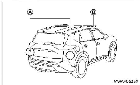
I due sensori radar (A) per il sistema Intelligent Blind Spot Intervention sono situati vicino al paraurti posteriore. Tenere sempre pulita la zona in prossimità dei sensori radar.
