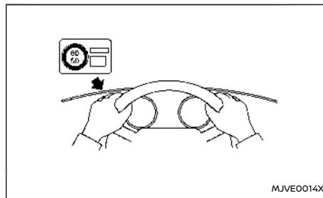
1. Prelevare l'adesivo con su scritto il limite di velocità dal compressore aria\*, quindi apporlo in un punto ben visibile dal conducente durante la guida.
