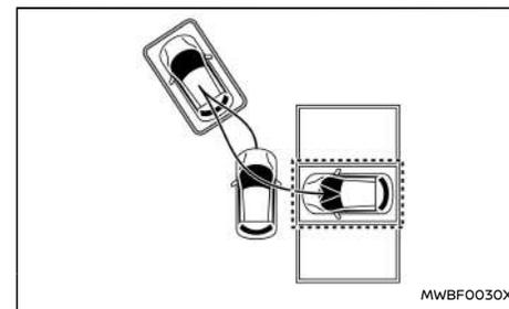
Il parcheggio assistito viene effettuato secondo un percorso come quello illustrato in figura.
