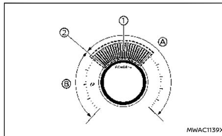
L'indicatore di potenza visualizza il consumo effettivo di energia da parte del motore elettrico
