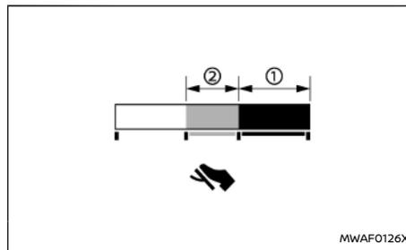
Il display Guida pedale ECO può essere selezionato sul display informativo multifunzione in modalità ECO. (Vedere "4. [Guida pedale ECO]" (pag.122). Usare la funzione Guida al pedale ECO per contenere il consumo di carburante.
