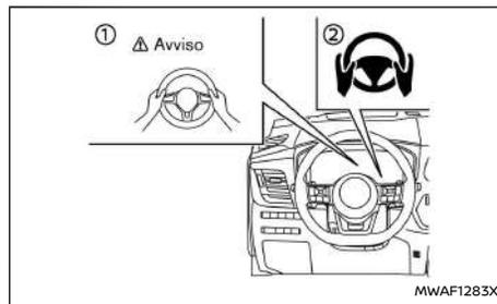
Quando la funzione Assistenza sterzata si attiva, controlla l'azionamento del volante da parte del conducente.
