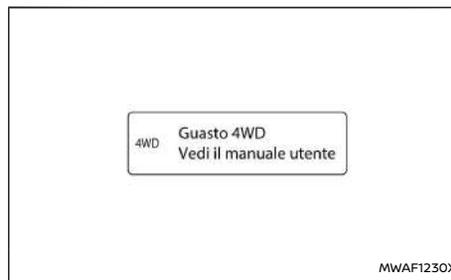
Se viene visualizzato l'avvertimento [Guasto 4WD Vedi il manuale utente], ci potrebbe essere un malfunzionamento nel sistema 4WD. Moderare la velocità del veicolo e fare controllare il veicolo il prima possibile da un concessionario NISSAN o un'officina qualificata.
