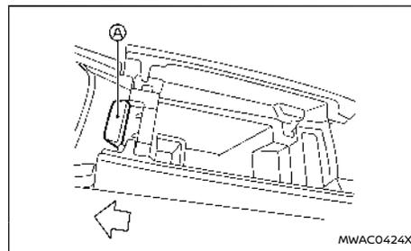
Per aprire i coperchi del cassetto della console, premere la manopola **A** nella parte posteriore.
