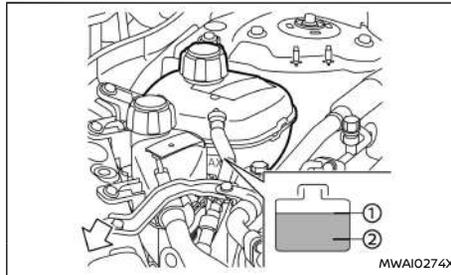
Controllare il livello del liquido refrigerante nel
