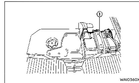
La batteria da 12 ① è situata sul vano bagagli. Per accedere alla batteria da 12 volt, sollevare il pannello del pianale del vano bagagli e rimuovere il portattrezzi.
