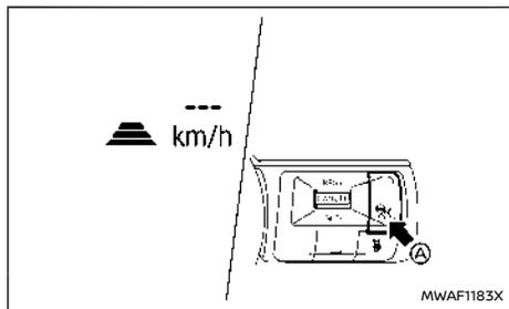
**Per attivare il cruise control**, premere e rilasciare velocemente l'interruttore Cruise ON/OFF (A). L'indicatore sistema ICC ON (grigio), l'indicatore distanza impostata e l'indicatore velocità impostata del veicolo si accendono in condizioni di standby per l'impostazione.
