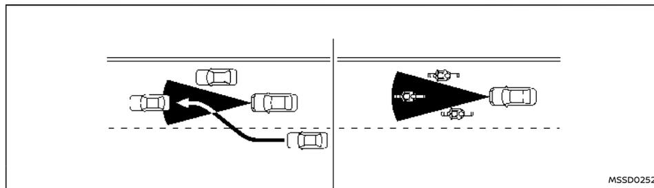
Il campo di rilevamento del sensore radar è limitato. Affinché il sistema possa mantenere la distanza di sicurezza dal veicolo davanti a sé in modalità di controllo della distanza di sicurezza, questo veicolo deve trovarsi nel campo di rilevamento del sensore.
