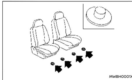
Questo veicolo include staffe per tappetini anteriori che fungono da ausilio per il posizionamento del tappetino. I tappetini originali NISSAN sono stati appositamente progettati per il modello del tuo veicolo.
