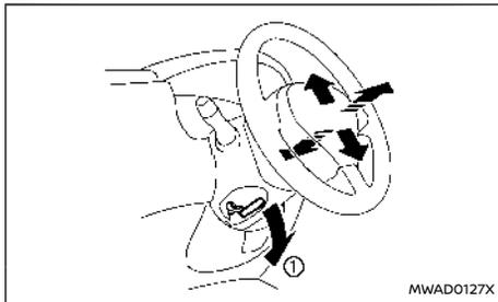
Abbassare la leva di bloccaggio ① e regolare lo sterzo verso l'alto, verso il basso, avanti o indietro, fino ad ottenere la posizione desiderata. Spingere la leva fermamente verso l'alto per bloccare lo sterzo.
