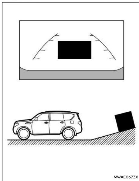
Facendo marcia indietro in salita, le linee distanziometriche e le linee guida dimensioni veicolo si presentano meno distanti di quanto non sia la distanza effettiva. Da notare che qualsiasi oggetto in salita è più lontano rispetto a come appare sul monitor.
