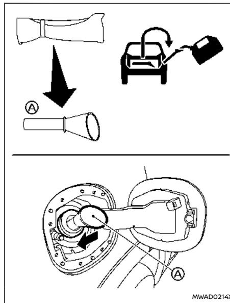
Se è necessario effettuare il rifornimento da un contenitore di carburante portatile, utilizzare l'imbuto **A** disponibile nella cassetta degli attrezzi (sotto la superficie di appoggio).
