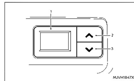
1. Display temperatura vano posteriore
