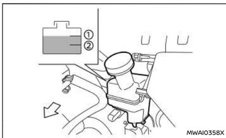
Controllare il livello del liquido nel serbatoio. Se il livello del liquido è al di sotto della tacca MIN ①, la spia di avvertimento dei freni si accenderà. Rabboccare con liquido fino alla tacca MAX ②. (Vedere "Capacità e lubrificanti/liquidi consigliati" (pag.482) per i tipi di liquido consigliati.)
