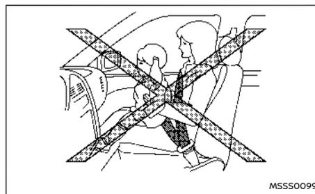
NISSAN raccomanda di sistemare neonati e bambini piccoli in appositi seggiolini di sicurezza. Scegliere un seggiolino per bambini adatto al veicolo e al bambino, osservando scrupolosamente le istruzioni fornite dalla casa produttrice del seggiolino per quanto riguarda l'installazione e l'uso.
