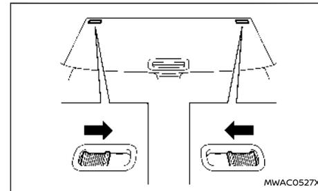
Prima di spostare la superficie di appoggio posteriore (esterna), rilasciare il blocco su entrambi i lati della superficie (se in dotazione) come illustrato.
