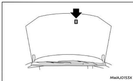
L'etichetta tecnica del climatizzatore è apposta sul lato inferiore del cofano, come illustrato.
