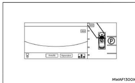
6. **Rilasciare il pedale del freno. Il veicolo si porta nella posizione corrispondente al rettangolo della posizione di cambio direzione (nella direzione della freccia sull'icona del veicolo).**
