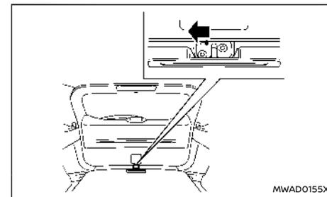
Se non si riesce ad aprire il portellone posteriore a causa della batteria 12 volt scarica, eseguire la procedura seguente.
