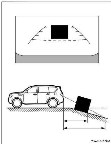
Facendo marcia indietro in discesa, le linee distanziometriche e le linee guida dimensioni veicolo si presentano più distanti di quanto non sia la distanza effettiva. Da notare che qualsiasi oggetto in discesa appare sul monitor più lontano di quanto non sia in realtà.
