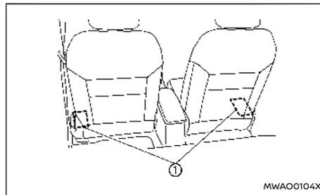
Le bocchette di ventilazione ① per il raffreddamento della batteria agli ioni di litio (Li-ion) si trovano sotto i sedili anteriori.
