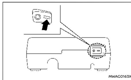
6. Portare il pulsante di avviamento in posizione ON. In seguito girare l'interruttore del compressore sulla posizione ON (-) e gonfiare lo pneumatico possibilmente al valore specificato sull'apposita targhetta affissa sul montante centrale lato conducente, o al valore minimo di 180 kPa (26 psi). Spegnerne brevemente il compressore d'aria per controllare la pressione dello pneumatico con il manometro.
