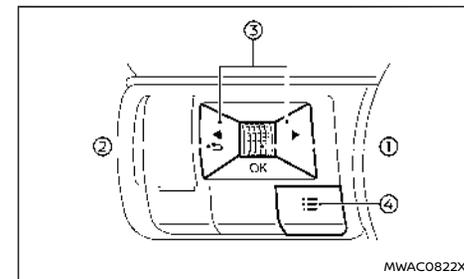
È possibile cambiare le impostazioni per il display informativo multifunzione usando la manopola a scorrimento ①, ② e ③ al volante.
