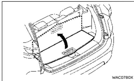
Per utilizzare la modalità verticale, inserire la superficie di appoggio nella fessura della finitura.
