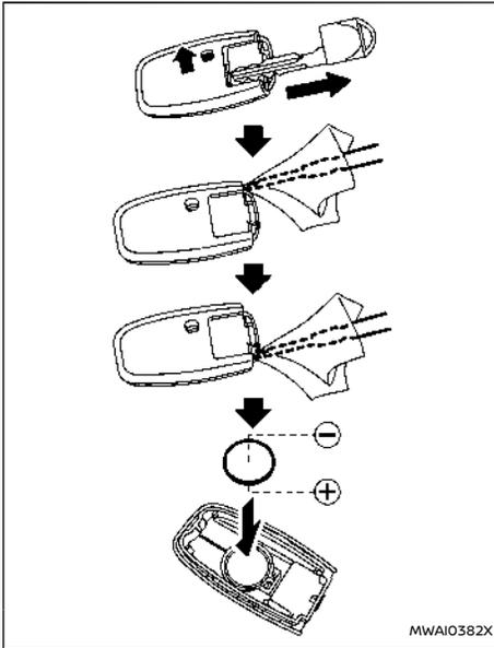
Sostituire la batteria dell'Intelligent Key come segue:
