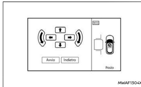
1. **Premere il pedale del freno e fermare il veicolo, quindi sfiorare l'icona di regolazione del riquadro del parcheggio
