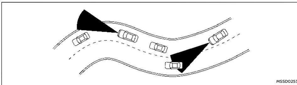
Quando si viaggia su strade tortuose, collinose, curve, strette o strade in costruzione, il sensore radar potrebbe rilevare veicoli presenti sull'altra corsia, o potrebbe temporaneamente non essere in grado di rilevare il veicolo davanti a sé. Il sistema ICC di conseguenza potrebbe decelerare o accelerare il veicolo.
