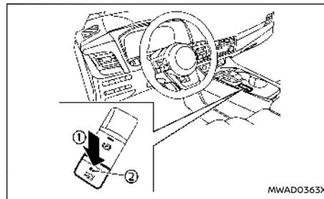
1. Con il pulsante di avviamento in posizione ON, premere l'interruttore della funzione di mantenimento automatico del freno ①. La spia sull'interruttore corrispondente ② si accende.
