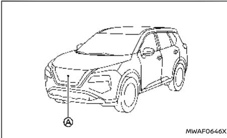
Il sensore radar (A) è situato sulla parte anteriore del veicolo.
