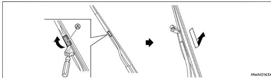
Sostituire le spazzole se sono usurate.
