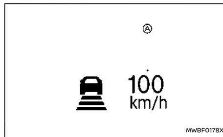
**Il conducente può escludere il sistema ICC premendo il pedale acceleratore.** L'indicatore di velocità impostata (A) lampeggerà quando la velocità del veicolo supera quella impostata. Il simbolo di rilevamento veicolo si spegne quando la strada di fronte al veicolo è libera. Rilasciando il pedale, il veicolo ritorna alla velocità di crociera precedentemente impostata.
