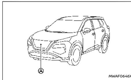
Il sistema Intelligent Forward Collision Warning utilizza un sensore radar (A) posto sul lato anteriore
