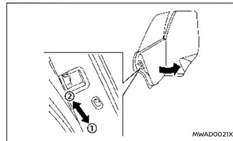
Il bloccaggio di sicurezza sulle porte posteriori impedisce l'apertura accidentale delle porte, spe-
