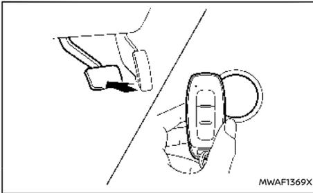
Se la batteria dell'Intelligent Key è scarica, oppure condizioni ambientali interferiscono con il funzionamento dell'Intelligent Key, avviare il sistema e-POWER secondo la procedura seguente:
