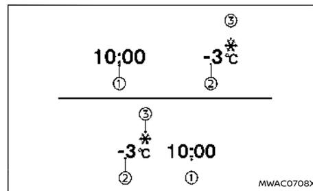
L'orologio ① e la temperatura esterna ② vengono visualizzati in alto sul display informativo multifunzione.
