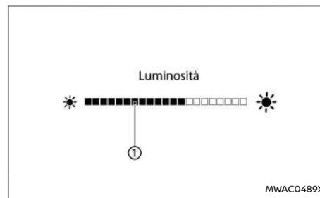
Il comando della luminosità del quadro strumenti può essere usato quando il pulsante d'avviamento è in posizione ON. Azionando il pulsante, il display informativo multifunzione passa alla modalità di regolazione della luminosità.
