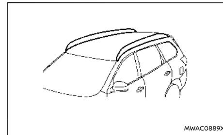
Non applicare alcun carico direttamente sui mancorrenti laterali del tetto. Le barre trasversali devono essere installate prima di applicare il carico/merci/bagagli sul tetto del veicolo. Per ulteriori informazioni, si consiglia di contattare un concessionario NISSAN o un'officina qualificata.
