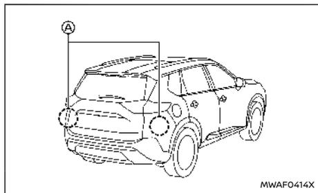
I due sensori radar **A** per il sistema RCTA si trovano vicino al paraurti posteriore. Tenere sempre pulita la zona in prossimità dei sensori radar.
