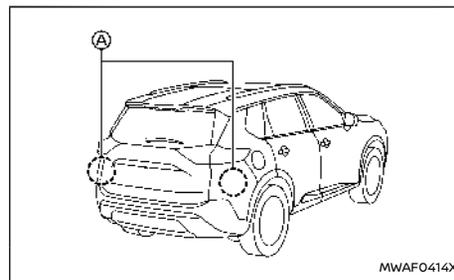
I due sensori radar (A) per il sistema BSW si trovano vicino al paraurti posteriore. Tenere sempre pulita la zona in prossimità dei sensori radar.
