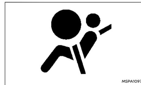
La spia di avvertimento airbag supplementare, che visualizza
