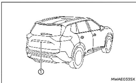
Per mostrare la vista posteriore, il sistema monitor per retromarcia usa una telecamera ① posta subito sopra la targa posteriore del veicolo.
