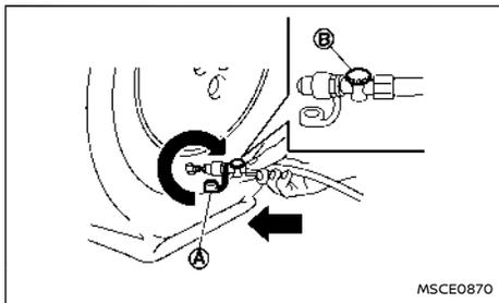
5. Rimuovere il tappo di protezione ④ dal tubo flessibile e avvitare saldamente il tubo flessibile sulla valvola dello pneumatico. Accertarsi che la valvola di sfiato ⑤ sia saldamente serrata. Controllare che l'interruttore del compressore d'aria sia sulla posizione OFF (O), quindi inserire la spina di corrente del compressore nella presa elettrica presente nel veicolo.
