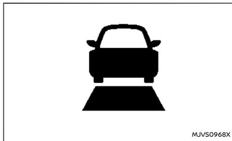
In caso di funzionamento improprio del sistema ICC, viene emesso un segnale acustico, viene visualizzato l'avviso del sistema ICC (giallo) e viene visualizzato l'avviso [Guasto al sistema Consultare il manuale dell'utente].
