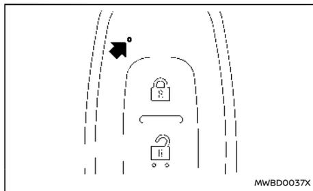
La spia lampeggia solo alla pressione di un pulsante sull'Intelligent Key. L'illuminazione della spia indica soltanto che l'Intelligent Key ha trasmesso un segnale. Poi vedendo e/o sentendo si può verificare se il veicolo ha effettuato l'operazione prevista. Se la spia non lampeggia, la batteria probabilmente è troppo debole per comunicare con il veicolo. In questo caso, si consiglia di sostituire la batteria.
