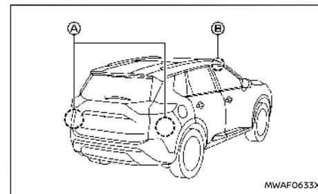
Il sistema Intelligent Blind Spot Intervention utilizza sensori radar (A) montati vicino al paraurti posteriore per rilevare altri veicoli presenti in una corsia adiacente. Oltre ai sensori radar, il sistema Intelligent Blind Spot Intervention utilizza una telecamera (B) montata dietro il parabrezza per monitorare le linee di demarcazione della corsia di marcia.
