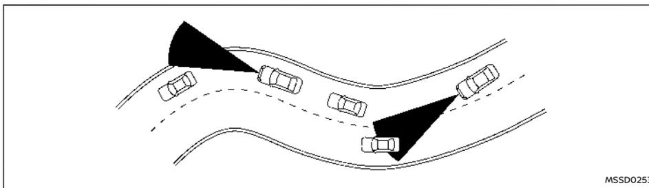
Quando si viaggia su determinate strade, come le strade tortuose, collinose, curve, strette o le strade in costruzione o in pendenza, il sensore potrebbe rilevare veicoli presenti sull'altra corsia, o potrebbe temporaneamente non essere in grado di rilevare un veicolo che precede. Questa condizione potrebbe essere causa di un funzionamento improprio del sistema.
