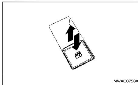
L'interruttore lato passeggero comanda soltanto il proprio finestrino. Quando il pulsante di bloccaggio dei finestrini sull'interruttore del conducente viene premuto, l'interruttore del passeggero posteriore non può essere azionato.
