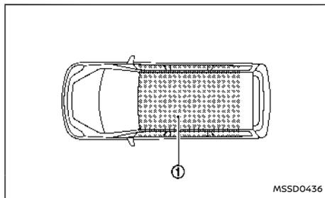
È possibile utilizzare l'Intelligent Key per avviare il sistema e-POWER solo quando questa si trova entro il raggio d'azione specificato ① come illustrato.
