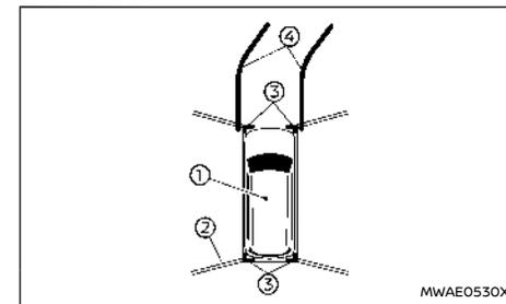
La vista a volo d'uccello mostra una visione dall'alto del veicolo, utile per determinare il posizionamento del veicolo e la traiettoria prevista verso un posto di parcheggio.
