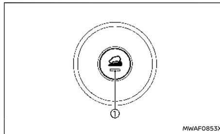
Quando occorre una frenatura supplementare su discese ripide, attivare il sistema di rallentamento in discesa portando l'interruttore del sistema su ON.
