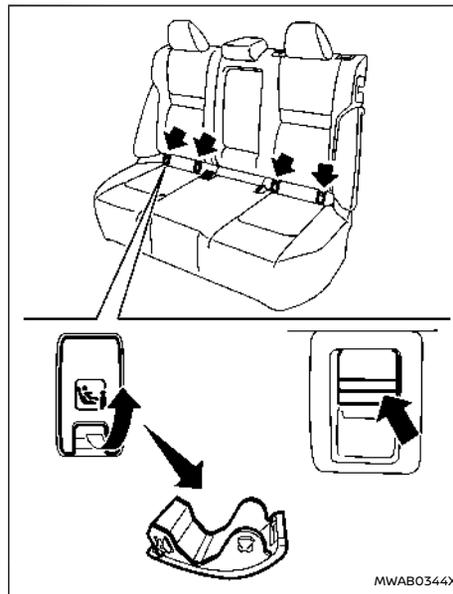
I punti di ancoraggio ISOFIX inferiori sono ubicati sotto i coperchi identificati con la scritta ISOFIX sul fondo dei cuscini dei sedili posteriori. Per accedere a un punto di ancoraggio ISOFIX inferiore, inserire il dito nel coperchio ed estrarlo.
