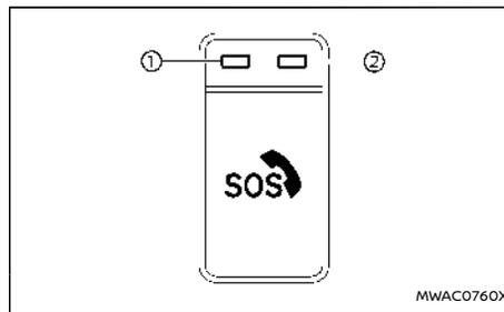
Le spie ① e ② sopra il pulsante SOS indicano lo stato del sistema di chiamata di emergenza del veicolo. Se la spia è accesa con luce rossa o se la spia non è accesa e si preme il pulsante SOS, la chiamata di emergenza al centro di emergenza potrebbe non essere effettuata. Inoltre, una chiamata di emergenza intelligente potrebbe non essere inviata in caso di collisione.
