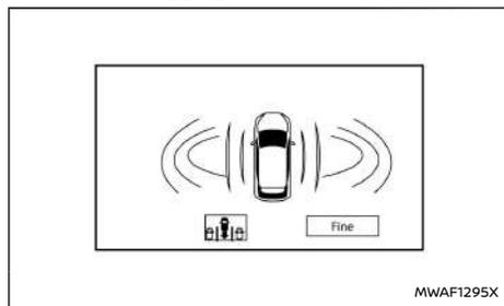
Quando il veicolo raggiunge o supera la velocità di circa 10 km/h (6 miglia/h) mentre è in corso il rilevamento della posizione di parcheggio, la schermata cambia. Quando la velocità del veicolo scende a 10 km/h (6 miglia/h) o meno, viene visualizzata di nuovo la schermata ProPILOT Park normale.
