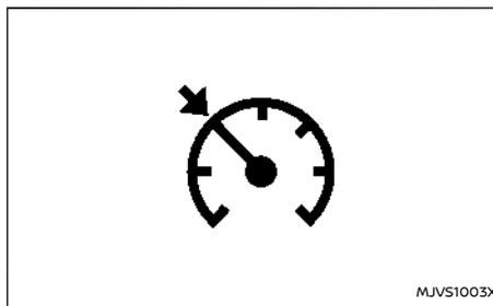
In caso di funzionamento improprio del sistema, viene emesso un segnale acustico e il colore dell'indicatore Cruise passa a giallo.
