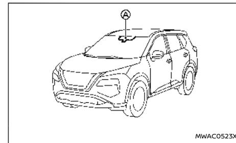
Il sensore ottico **A** per il sistema di assistenza abbaglianti si trova di fronte allo specchietto retrovisore interno. Per mantenere il sistema di assistenza abbaglianti in buone condizioni opera-
