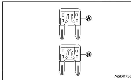
6. Se il fusibile è bruciato **A**, sostituirlo con un nuovo **B**.
