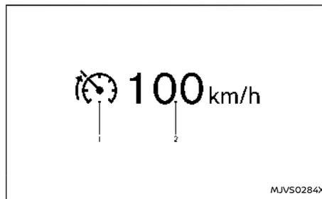
Le condizioni operative del limitatore di velocità sono visualizzate sul display informativo multifunzione.
