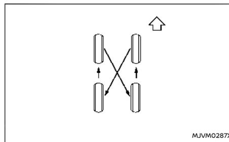
NISSAN raccomanda di eseguire la rotazione dei pneumatici ogni 5.000 km (3.000 miglia) per i modelli a trazione integrale (4WD) oppure ogni 10.000 km (6.000 miglia) per i modelli a due ruote motrici (2WD). Tuttavia, gli intervalli per la rotazione degli pneumatici possono variare a seconda delle abitudini di guida e le condizioni del fondo stradale. (Vedere "Foratura di uno pneumatico" (pag.427) per la sostituzione degli pneumatici.)
