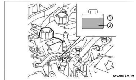
Controllare il livello del liquido refrigerante nella vaschetta di espansione a motore freddo. Se il
