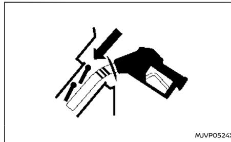
Il serbatoio carburante non è dotato di tappo del bocchettone di rifornimento. Dopo aver aperto lo sportello del bocchettone di rifornimento carburante, inserire l'ugello della pompa carburante direttamente nell'apertura del bocchettone. Quando si estrae l'ugello della pompa carburante, l'apertura del bocchettone viene sigillata.
