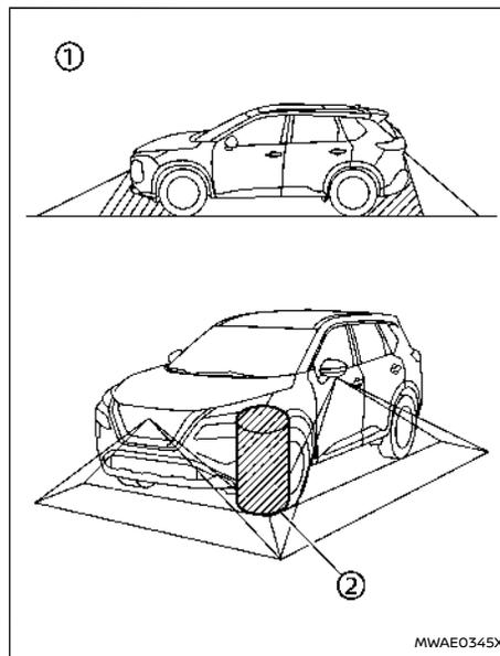
Ci sono alcune aree intorno al veicolo in cui il sistema non è in grado di rilevare oggetti, motivo per il quale il sistema non avvertirà della presenza di oggetti in movimento. Quando viene proiettata la vista anteriore o posteriore, un oggetto che si trovi sotto il paraurti o per terra potrebbe anche
