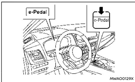
Il sistema e-Pedal Step viene attivato o disattivato ogni volta che viene azionato l'interruttore <e-Pedal> (sulla consolle centrale). (L'indicatore e-Pedal sul display informativo multifunzione mostra lo stato del sistema e-Pedal Step.)
