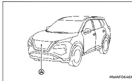
Il sensore per il sistema ICC **A** è collocato nella parte anteriore del veicolo.
