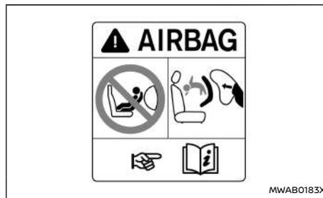
“Non installare MAI un seggiolino per bambini rivolto nel senso inverso di marcia su un sedile dotato di AIRBAG, SALVO PRECEDENTE DISATTIVAZIONE dell'airbag; altrimenti si rischiano LESIONI GRAVI o MORTE del bambino in caso di incidente.”
