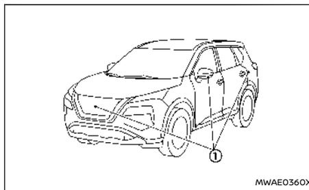
Per mostrare le diverse viste, il sistema Intelligent Around View Monitor usa le telecamere ① poste sulla griglia anteriore, sugli specchietti retrovisori esterni del veicolo e sopra la targa posteriore del veicolo.
