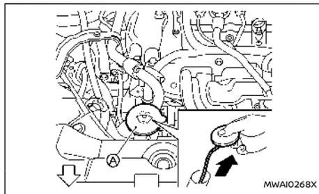
Controllare il livello del liquido di lavaggio nel serbatoio. Tappare con un dito il foro al centro del complessivo tappo/tubo (come illustrato in figura) e quindi estrarlo dal serbatoio. Se nel tubo non c'è liquido, aggiungere liquido di lavaggio.
