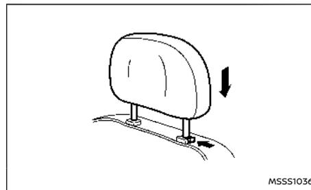
Per abbassarlo, tenere premuta la manopola di bloccaggio e spingere in basso il poggiatesta.
