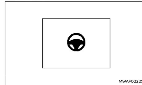
L'interruttore Assistenza sterzata è utilizzato per attivare o disattivare temporaneamente il sistema Assistenza sterzata.
