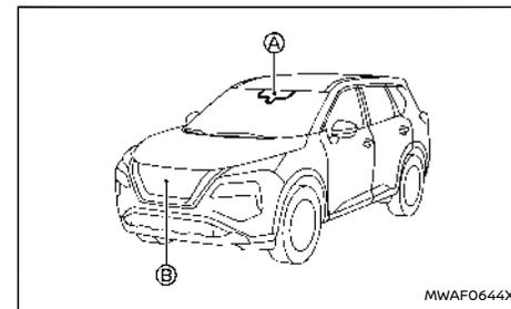
Il sensore radar (B) si trova sulla parte anteriore del veicolo. La telecamera (A) è collocata in alto sul parabrezza.
