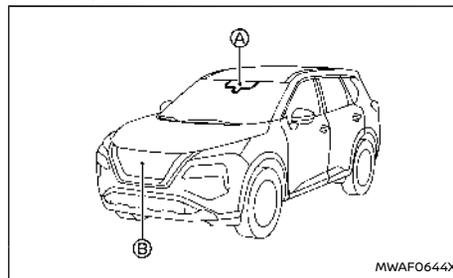
Il sistema Intelligent Emergency Braking con rilevamento pedone utilizza un sensore radar (B) situato sulla parte anteriore del veicolo per misurare la distanza dal veicolo che precede sulla stessa corsia di marcia.
