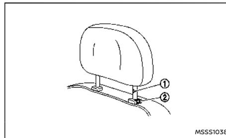
1. Allineare le aste del poggiatesta con i fori presenti nel sedile. Assicurarsi che il poggiatesta sia posizionato nel senso corretto. L'asta con la tacca di regolazione ① deve essere inserita nel foro dotato di pulsante di bloccaggio ②.
