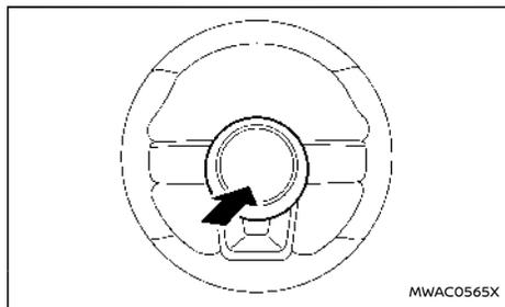
L'avvisatore acustico è sempre operativo, indipendentemente dalla posizione del pulsante d'avviamento, a meno che non sia scarica la batteria da 12 volt.
