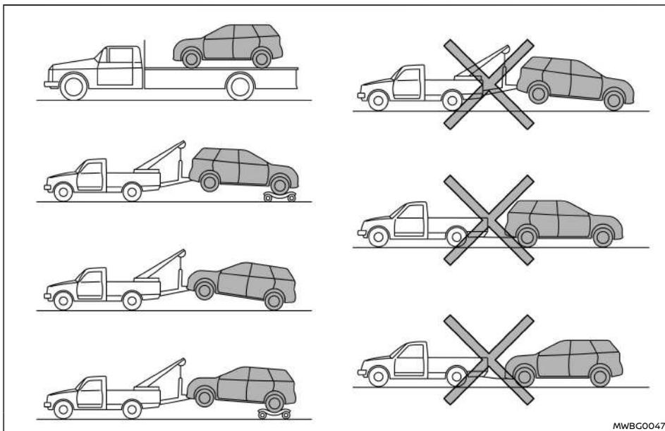
NISSAN raccomanda di far trainare il vostro veicolo con le ruote motrici (anteriori) sollevate da terra o di collocare il veicolo su un autocarro con pianale senza sponde, come illustrato in figura.
