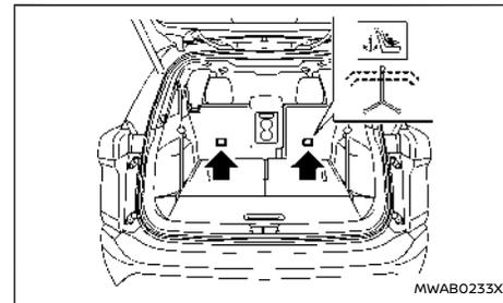
Gli ancoraggi sono ubicati nei punti illustrati. Posizionare la cinghia top tether sulla parte superiore dello schienale e agganciarla all'apposito ancoraggio che fornisce l'installazione più diritta. Stringere la cinghia top tether secondo le istruzioni del produttore per eliminare l'eventuale lasco presente.
