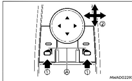
Il comando elettrico dello specchietto retrovisore esterno si trova sul bracciolo del conducente.
