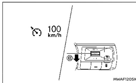
Per impostare la velocità di crociera, accelerare il veicolo fino alla velocità desiderata, quindi premere verso il basso l'interruttore **<CANCEL>** verso SET- **B** e rilasciarlo. (Il colore dell'indicatore Cruise cambia in verde e si accende l'indicatore della velocità impostata per il veicolo.) Togliere il piede dal pedale dell'acceleratore. Il veicolo manterrà la velocità impostata.
