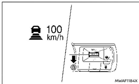
**Per impostare la velocità di crociera**, accelerare il veicolo fino alla velocità desiderata, premere verso il basso l'interruttore **<CANCEL>** verso SET- (B) e rilasciarlo. (L'indicatore sistema ICC ON (grigio), l'indicatore distanza impostata e l'indicatore velocità impostata del veicolo si accendono.) Togliere il piede dal pedale dell'acceleratore. Il veicolo manterrà la velocità impostata.
