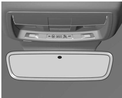
L'abbagliamento proveniente dai veicoli che seguono viene automaticamente ridotto, quando si guida al buio.
