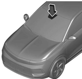
Non attaccare autoadesivi come vignette autostradali o simili sul parabrezza nell'area dello specchietto interno. Mantenere il sensore libero da polvere, sporco e ghiaccio. In caso contrario, l'area di rilevamento del sensore pioggia/ sensore luce e l'area di visione della telecamera nell'alloggiamento dello specchietto potrebbero subire limitazioni. → pagina 45
