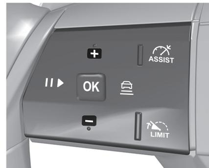
La velocità preimpostata si può modificare premendo + per aumentarla oppure - per diminuirla. Premere brevemente per modificare la velocità di 1 km/h, una pressione lunga del pulsante modifica la velocità di 5 km/h.
