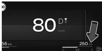
Indica il livello del carburante nel serbatoio.
