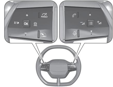
Tramite i comandi al volante è possibile controllare alcuni sistemi di assistenza al conducente, il sistema Infotainment e il telefono cellulare collegato.
