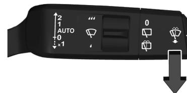
Tirare la leva. Il liquido di lavaggio viene spruzzato sul parabrezza e il tergicristalli effettua alcuni passaggi.
