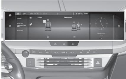
Regolare la ventilazione sull'intensità desiderata premendo
