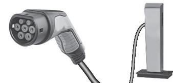
PHEV: Il tempo di ricarica richiede circa tre ore e 25 minuti con il caricatore a bordo da 3,7 kW e 16 A. Per il caricatore a bordo da 7,4 kW e da 32 A, il tempo di ricarica richiede circa un'ora e 40 minuti.
