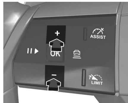
Premere il pulsante per visualizzare l'impostazione della distanza corrente nel quadro strumenti.
