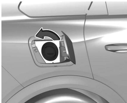
Posizionare l'ugello in posizione rettilinea rispetto al bocchettone di rifornimento e premere delicatamente per inserirlo.
