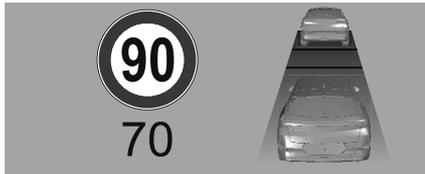
Se il sistema rileva un veicolo sul percorso di guida, la schermata del cruise control adattivo cambia di conseguenza.
