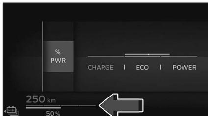
Visualizza lo stato di carica della batteria ad alta tensione.
