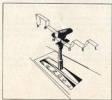
La figura illustra l'innesto ed il disinnesto delle varie posizioni della leva selettoria.
