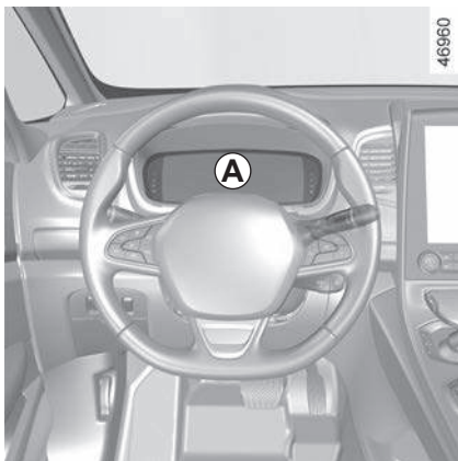
Il quadro della strumentazione A si illumina all'inserimento del contatto.
