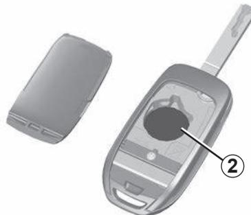
**Nota:** quando si sostituisce la pila, si raccomanda di non toccare il circuito elettronico situato nel coperchio della chiave.
