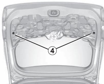
Ruotate il portalamпада **4** in senso antiorario e sostituite la lampadina.
