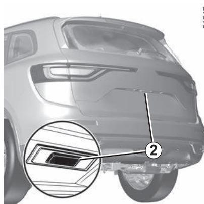
Mediante il comando esterno di apertura del portellone
