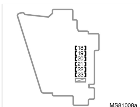
Basetta di giunzione quadro strumenti (lato sinistro)
