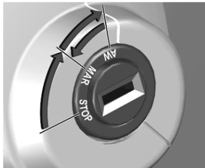
1. Azionare il pedale del freno e con il freno di stazionamento inserito, ruotare brevemente la chiave in posizione **AVV** e rilasciarla. Un messaggio corrispondente appare nel display dello specchietto retrovisore.
