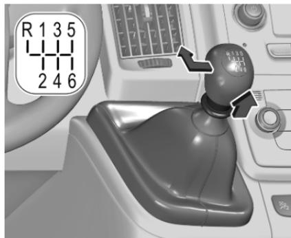
Per inserire la retromarcia, premere il pedale della frizione, tirare l'anello situato sotto alla leva del cambio e portare quest'ultima completamente a sinistra e in avanti.
