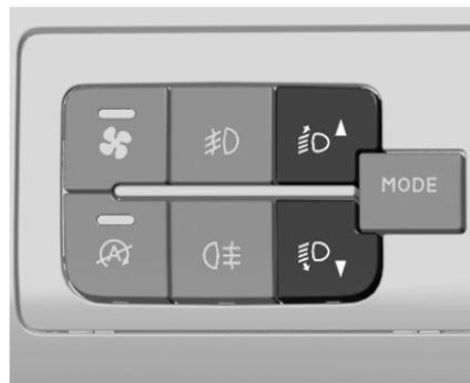
Per regolare la profondità delle luci in base al carico del veicolo e non abbagliare i conducenti dei veicoli in avvicinamento: premere il pulsante
