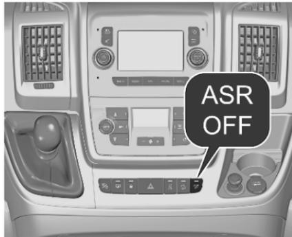
Il sistema controllo trazione e il sistema di controllo della trazione possono essere disattivati se necessario: premere **ASR OFF**.
