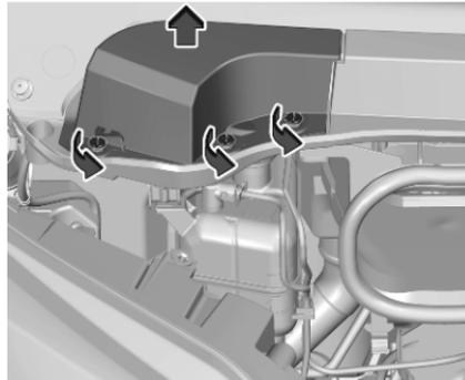
Per accedere al tappo del serbatoio, rimuovere il coperchio protettivo ruotando le tre viti di fissaggio di un quarto di giro.
