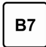
Carburante diesel conforme alla norma EN590 mescolato con un biocombustibile conforme alla norma EN14214 (possibilmente con una percentuale di estere metilico di acidi grassi superiore al 7%)
