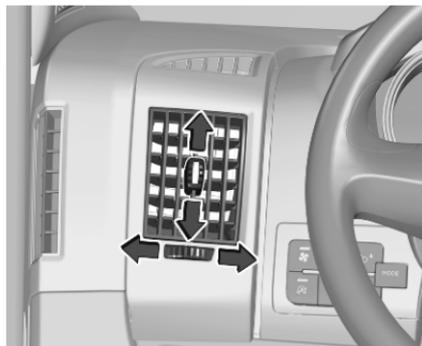
Regolare la direzione del flusso d'aria modificando l'inclinazione delle alette della bocchetta.
