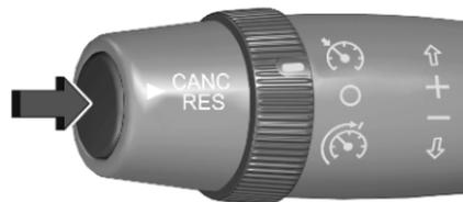
Premere il pedale del freno, il pedale della frizione o premere il pulsante all'estremità della leva. Il controllo automatico della velocità di crociera è in modalità di pausa. Si sta guidando il veicolo senza il controllo automatico della velocità di crociera.
