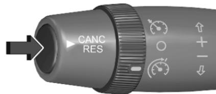
Premere il pulsante sull'estremità della leva per disattivare la funzionalità. Il limitatore di velocità è in modalità pausa e viene visualizzato un messaggio.
