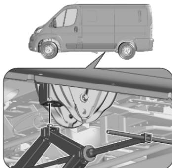
4. Controllare che il martinetto sia in posizione corretta sotto il relativo punto di sollevamento del veicolo vicino alla ruota posteriore.
