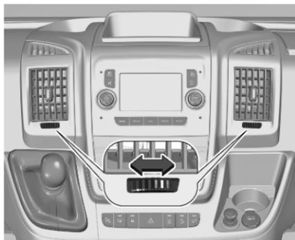
Regolare la quantità di aria all'uscita della bocchetta ruotando la manopola di regolazione. La bocchetta viene chiusa ruotando la rotella di regolazione a fine corsa a destra o a sinistra.
