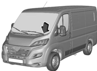
Il numero di telaio del veicolo è stampigliato sul quadro strumenti, visibile attraverso il parabrezza.
