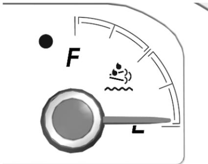
L'indicatore di livello AdBlue mostra il livello corrente di AdBlue nel serbatoio.
