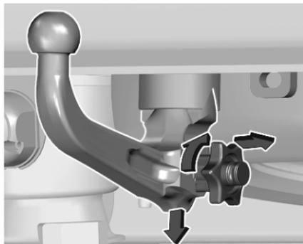
Aprire il coperchietto di protezione e ruotare la chiave in posizione
