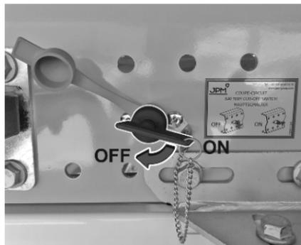
Il sistema deve essere attivato con il sezionatore sul lato sinistro del telaio. Inserire la chiave dopo aver rimosso il tappo protettivo.
