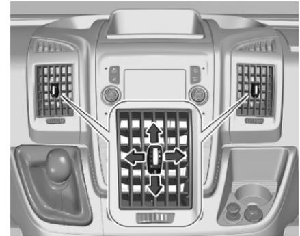
Regolare la direzione del flusso d'aria modificando l'inclinazione orizzontale e verticale delle alette della bocchetta.
