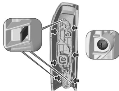
3. Rimuovere le sei viti di fissaggio dal portalampada. Aprire le tre linguette di fissaggio ed estrarre il portalampada dal suo alloggiamento.
