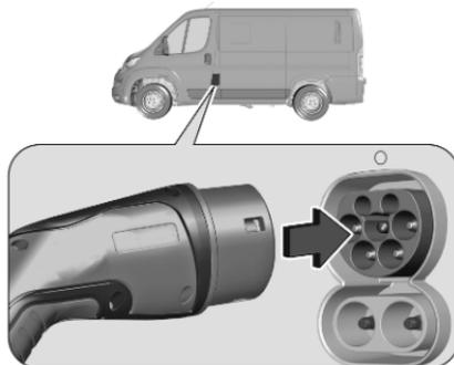
5. Rimuovere la copertura protettiva e la presa del cavo di carica nella presa di carica del veicolo.
