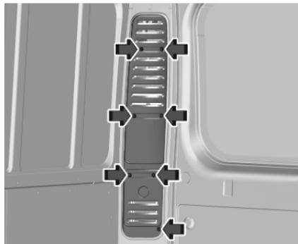
1. Svitare le sette viti di fissaggio con un cacciavite e in seguito rimuovere il coperchio.
