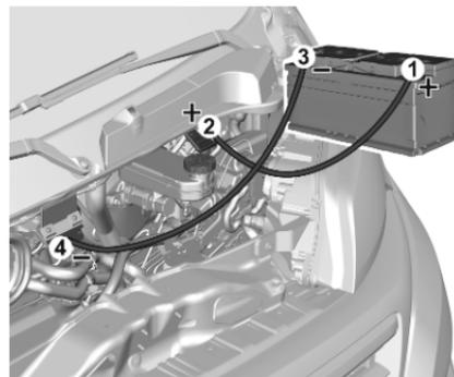
Aprire i cappelli di protezione dei terminali positivi di entrambe le batterie del veicolo.
