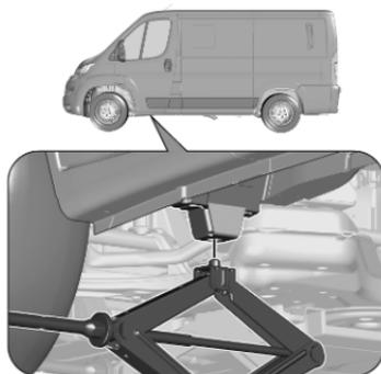
3. Controllare che il martinetto sia in posizione corretta sotto il relativo punto di sollevamento del veicolo vicino alla ruota anteriore.
