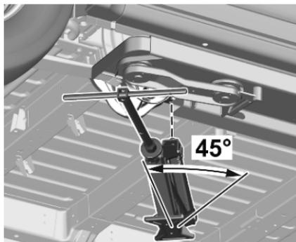
6. Se il veicolo è dotato di pedana laterale, il martinetto deve essere posizionato a  $45^\circ$  per non interferire con la pedana laterale.
