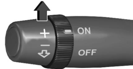
Accelerare fino alla velocità desiderata e spostare la leva di comando verso l'alto + per circa un secondo. La velocità corrente viene memorizzata e mantenuta. Il pedale dell'acceleratore può essere rilasciato.
