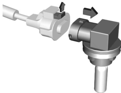
4. Disinserire il connettore a spina tirando sulla linguetta di fermo.
