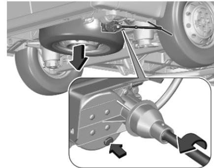
2. Montare la prolunga, il supporto e la barra correttamente su una chiave e montarla sul bullone di fissaggio.
