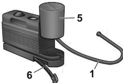
1. Ruotare in senso antiorario la cartuccia da sostituire e sollevarla.
