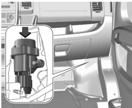
Per ripristinare l'alimentazione del carburante, premere il pulsante sul dispositivo di interruzione dell'alimentazione.
