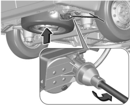
9. Posizionare la chiave sulla vite del supporto e ruotare in senso orario fino a quando la ruota non sia sollevata completamente.
