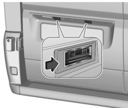
1. Inserire un cacciavite in una delle cavità della copertura ed estrarre facendo leva. Rimuovere la copertura.
