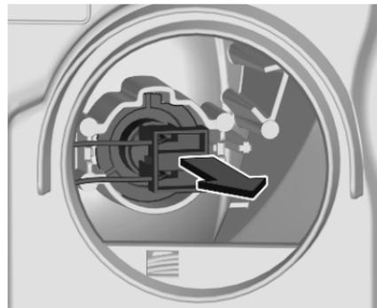
2. Rilasciare la molla di bloccaggio premendo il fermo centrale.
