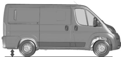
Per agevolare il caricamento o scaricamento del veicolo, l'altezza della soglia di caricamento posteriore può essere regolata.
