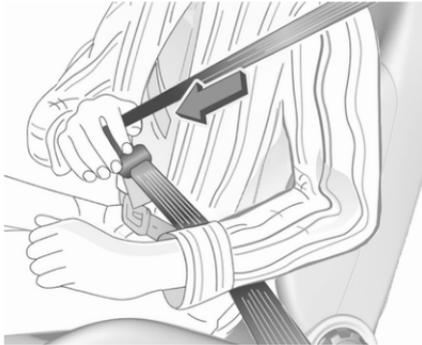
Estrarre la cintura di sicurezza dal riavvolgitore, farla passare sul corpo, accertando che non sia attorcigliata, e inserire la linguetta di chiusura nella fibbia bloccandola in posizione. Accertarsi che la cintura di sicurezza poggi sulla spalla e aderisca perfettamente al corpo durante la guida.
