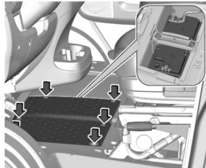
La batteria del veicolo si trova sotto il pavimento anteriore di sinistra. Smontare il pannello per accedere alla batteria del veicolo.
