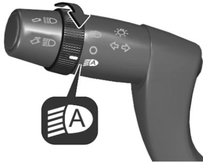
Quando la funzione di comando automatico dei fari è attivata e il motore è in funzione, il sistema passa dalle luci diurne all'accensione dei fari automaticamente, a seconda delle condizioni della luminosità esterna.
