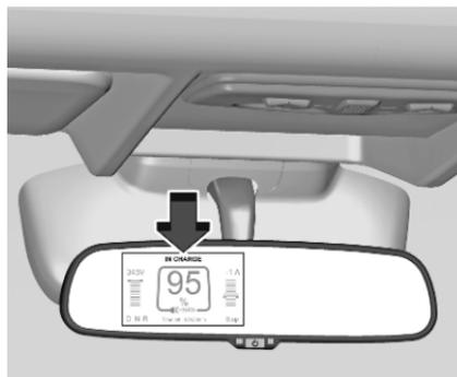
Un messaggio visualizzato sul display nello specchietto retrovisore indica quando la batteria ad alta tensione è completamente carica.
