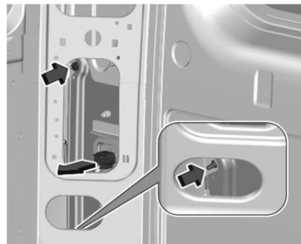
2. Scollegare il connettore elettrico premendo sulla sua linguetta centrale. Rimuovere i due dadi di fissaggio dall'unità lente. Dall'esterno, rimuovere l'unità lente.
