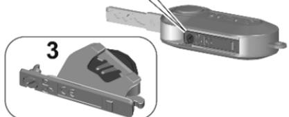
2. Girare la vite con un cacciavite sottile dalla posizione di blocco alla posizione aperta.
