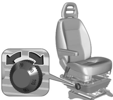
Ruotare la manopola per regolare il grado di sensibilità del sedile con molleggio in base al peso del conducente.
