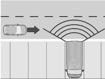
Il sistema rileva veicoli che si muovono verso entrambi i lati dietro al veicolo a una velocità compresa tra 1 km/h fino a circa 35 km/h.
