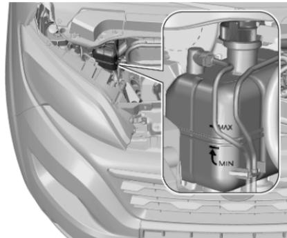
Quando il sistema di raffreddamento è freddo, il livello del liquido di raffreddamento dovrebbe essere al di sopra del segno **MIN**. Rabboccare se il livello è basso.
