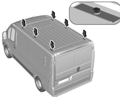
Montare il portapacchi utilizzando i punti di supporto indicati in figura.
