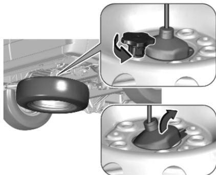
4. Svitare la manopola di fissaggio. Rimuovere il supporto inclinando un lato.
