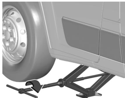
Con il martinetto correttamente allineato, ruotare la chiave ruota fino a quando la ruota non poggi più per terra.
