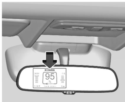
L'inizio della ricarica viene indicata da un messaggio sul display dello specchietto retrovisore.
