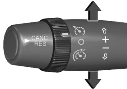
Accelerare fino alla velocità desiderata e spostare la leva di comando verso l'alto + per circa un secondo. La velocità corrente viene memorizzata e mantenuta. Il pedale dell'acceleratore può essere rilasciato.
