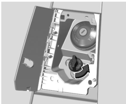
3. Ruotare il tappo protettivo del serbatoio AdBlue di un 6° di giro in senso antiorario e rimuoverlo.
