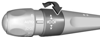
Ruotare la rotellina di comando due volte per attivare o disattivare i retronebbia.
