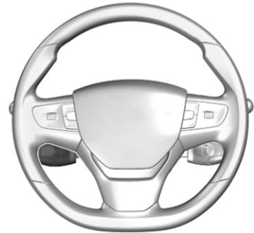
Controllo automatico della velocità di crociera, Cruise control semi-adattivo e limitatore di velocità vengono azionati attraverso il controllo assistenza al conducente sul lato sinistro del piantone dello sterzo.
