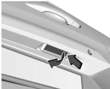
Inserire un cacciavite in una delle cavità della copertura ed estrarre facendo leva. Rimuovere la copertura.
