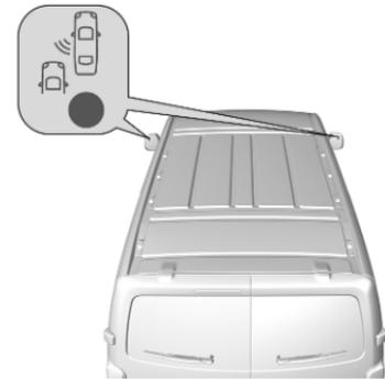
Se il sistema rileva un veicolo nell'angolo morto laterale durante la marcia in avanti, un LED si accende nel rispettivo specchietto.
