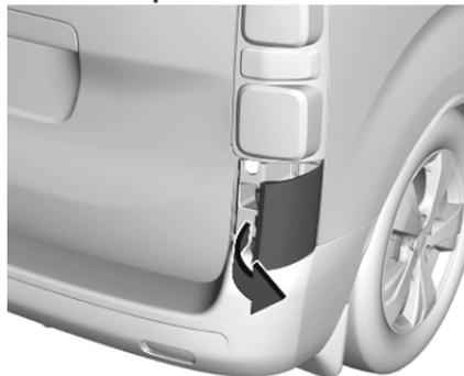
1. Veicoli con copertura che nasconde la vite del gruppo ottico posteriore basso: rimuovere con cautela la copertura sbloccando le linguette di fermo con un cacciavite e inclinando leggermente la copertura verso l'esterno.
