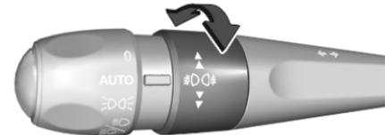
Ruotare la rotellina di comando una volta per attivare o disattivare i fendinebbia anteriori.
