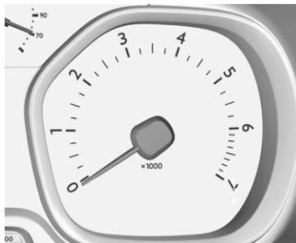
Indica la velocità di rotazione del motore.
