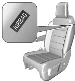
Il sistema airbag laterale è formato da due airbag, uno su ciascun bracciolo del sedile anteriore. La loro presenza viene segnalata dalla scritta **AIRBAG**.
