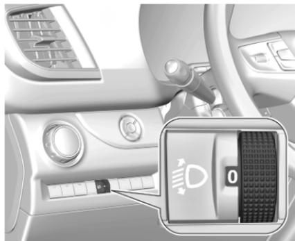
Per regolare la profondità delle luci in base al carico del veicolo e non abbagliare i conducenti dei veicoli in avvicinamento: ruotare l'interruttore rotante
