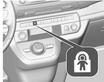
Sistema ad azionamento da remoto per impedire l'apertura delle portiere scorrevoli mediante le maniglie interne.
