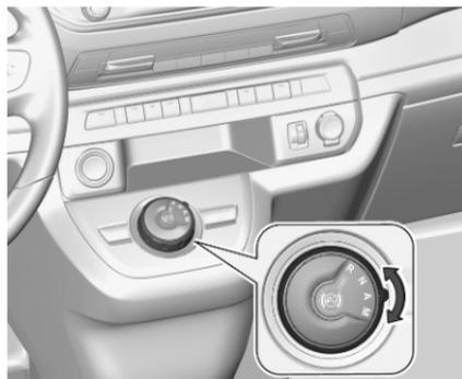
Spostare la leva del cambio in posizione **M** se il veicolo è fermo.
