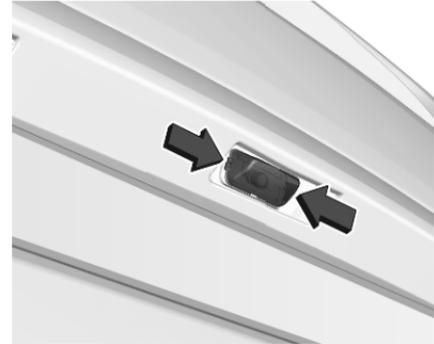
Inserire un cacciavite sottile, ad es. in una delle cavità della copertura e spingerlo verso l'esterno per sganciarlo. Rimuovere la copertura.
