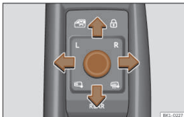
Fig. 99 Particolare della porta del conducente: comandi per gli specchietti retrovisori esterni.
