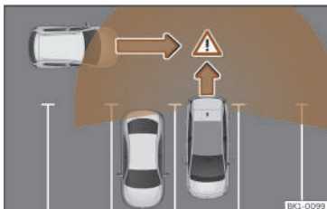
Fig. 147 Rappresentazione schematica dell'assistente all'uscita dal parcheggio: zona vigilata intorno al veicolo che sta uscendo dal parcheggio.
