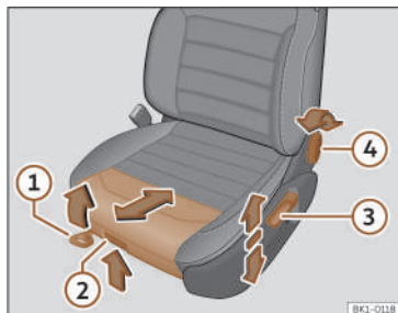
Fig. 84 Sedili anteriori: regolazione manuale del sedile.
