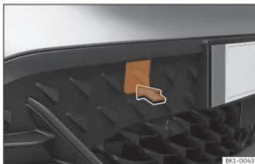
Fig. 177 Sul lato destro del paraurti anteriore:staccare il coperchio.
