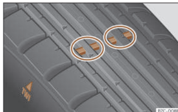
Fig. 190 Profilo dello pneumatico: indicatori di usura.
