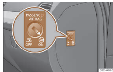
Fig. 26 Interruttore a chiave per l'attivazione e la disattivazione dell'airbag del passeggero.
