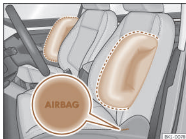
Fig. 30 Airbag laterale all'interno del sedile del conducente e del passeggero.
