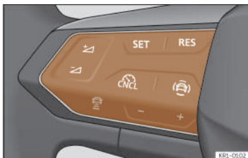
Fig. 118 Sul volante multifunzione: tasti per gestire l'ACC.
