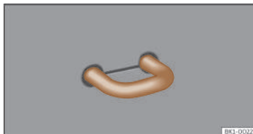
Fig. 166 Nel bagagliaio: occhielli di ancoraggio.
