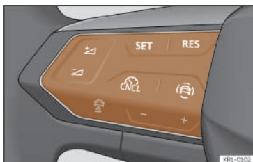
Fig. 115 Nel volante multifunzione: tasti per gestire il limitatore di velocità.
