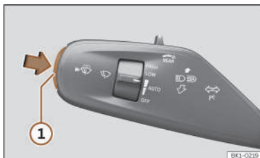
Fig. 172 Leva del tergicristalli
