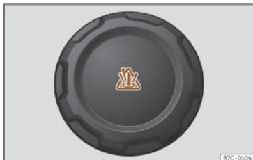
Fig. 186 Vano anteriore: tappo del serbatoio di compensazione del liquido di raffreddamento.
