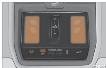
Fig. 95 Particolare della copertura del tetto: illuminazione anteriore dell'abitacolo.
