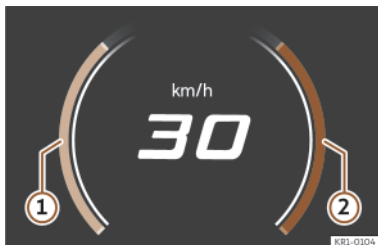
Fig. 3 Sul quadro strumenti digitale: indicatore di potenza (rappresentazione schematica).
