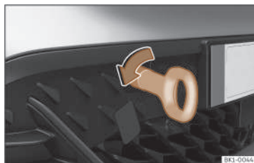
Fig. 178 Paraurti anteriore destro: occhiello di traino avvitato.
