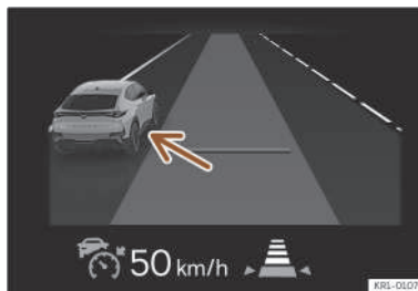
Fig. 119 Sul display del quadro strumenti: ACC attivo, veicolo rilevato sulla sinistra.
