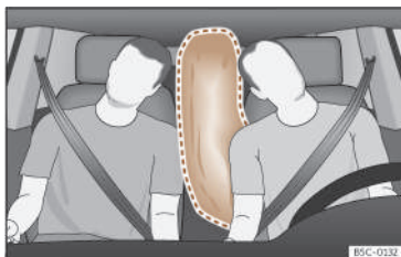
Fig. 29 Airbag centrale completamente gonfiato (area di spiegamento).
