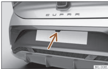
Fig. 114 Nel paraurti posteriore: posizione della telecamera dell'assistente alla retromarcia.
