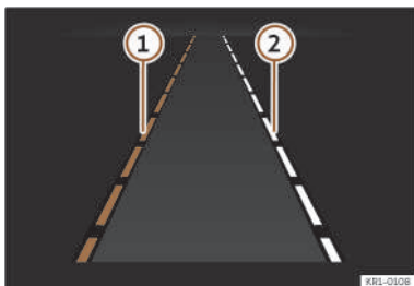
Fig. 124 Nello schermata del quadro strumenti: indicazioni del sistema di assistenza per il mantenimento della corsia.
