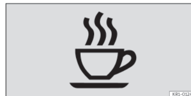
Fig. 5 Sul display del quadro strumenti: Simbolo del sistema di monitoraggio della sonnolenza.
