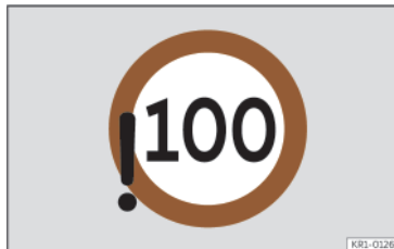
Fig. 8 Sul display del quadro strumenti: superamento della velocità massima ammessa (illustrazione).
