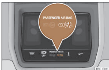
Fig. 27 Nella console del tetto: spia di controllo della disattivazione dell'airbag del passeggero.
