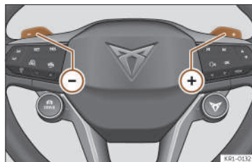
Fig. 107 Volante multifunzione: leve per il recupero dell'energia.
