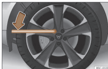
Fig. 194 Cambio di una ruota: come allentare le viti delle ruote.
