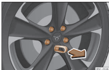
Fig. 192 Ruota: viti della ruota con tappi.
