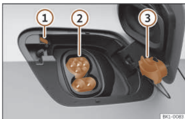
Fig. 58 Dietro il coperchio della presa di carica della batteria, nella parte posteriore destra: presa di carica.
