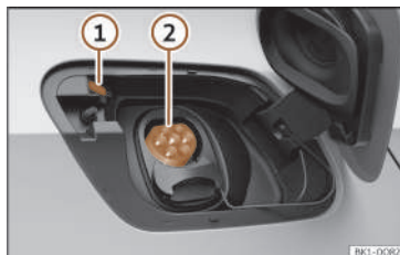
Fig. 52 Dietro il coperchio di ricarica della batteria nella parte posteriore destra: Presa di carica.
