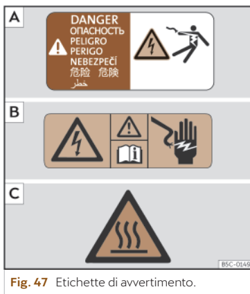
Fig. 48 Etichette di avvertimento nella batteria ad alta tensione.
