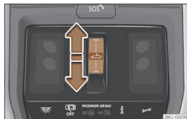
Fig. 96 Nel rivestimento interno del tetto: tasto di funzione per gestire la tendina parasole.
