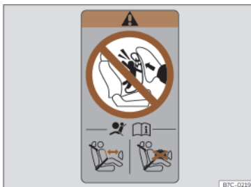
Fig. 35 Adesivo dell'airbag: nel telaio posteriore della porta lato passeggero.
