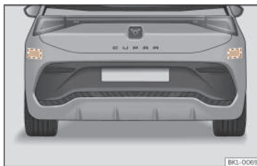
Fig. 105 Veduta posteriore del veicolo: zone dei sensori radar.
