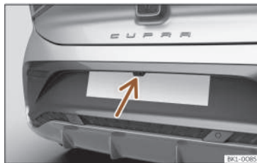
Fig. 107 Nel paraurti posteriore: posizione della telecamera dell'assistente alla retromarcia.
