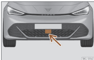
Fig. 102 Sul paraurti anteriore: sensore radar.
