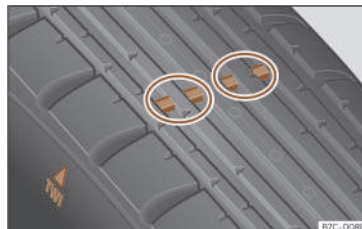
Fig. 180 Profilo dello pneumatico: indicatori di usura.
