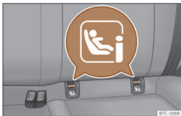
Fig. 36 Sedile posteriore: posizione degli occhielli di fissaggio del sistema ISOFIX o i-Size.
