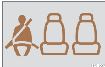
Fig. 17 Quadro strumenti: indicazione dello stato delle cinture di sicurezza delle postazioni posteriori.
