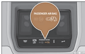
Fig. 26 Nella console del tetto: spia della disattivazione degli airbag del passeggero anteriore.
