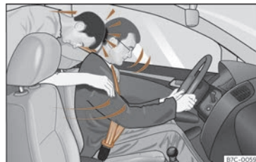
Fig. 18 Se non indossa la cintura, il passeggero seduto sul sedile posteriore viene scagliato in avanti, colpendo il conducente (che invece indossa la cintura).
