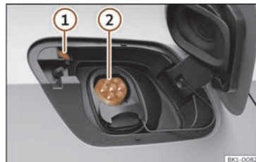
Fig. 48 Dietro il coperchio di ricarica della batteria nella parte posteriore destra: Presa di carica
