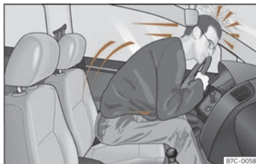
Fig. 17 Il conducente che non indossa la cintura di sicurezza viene proiettato in avanti.
