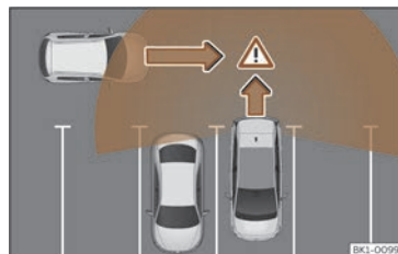
Fig. 115 Rappresentazione schematica dell'assistente di uscita dal parcheggio: zona vigilata attorno al veicolo che sta uscendo dal parcheggio.
