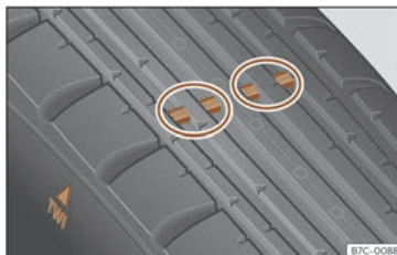
Fig. 162 Spessore del battistrada dello pneumatico: indicatori di usura.
