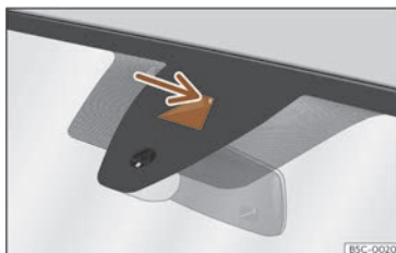
Fig. 111 Nel parabrezza: area del campo visivo del dispositivo di assistenza per il mantenimento della corsia.
