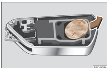
Fig. 70 Chiave del veicolo: rimozione della pila.
