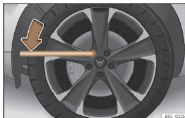
Fig. 195 Cambio di una ruota: come allentare le viti delle ruote.
