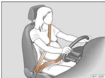
Fig. 23 Posizione del nastro della cintura di sicurezza per donne in stato di gravidanza.
