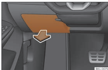
Fig. 179 Sul cruscotto del lato del conducente: coperchio della scatola portafusibili.
