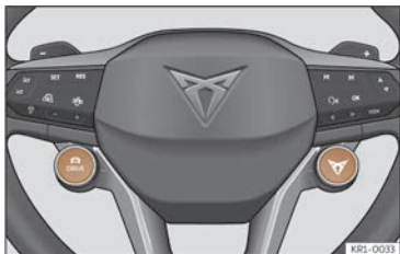
Fig. 108 Volante multifunzione: Pulsanti DRIVE e CUPRA per selezionare e cambiare il profilo di guida.
