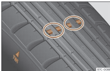
Fig. 190 Profilo dello pneumatico: indicatori di usura.
