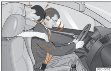
Fig. 19 Se non indossa la cintura, il passeggero seduto sul sedile posteriore viene scagliato in avanti, colpendo il conducente (che invece indossa la cintura).
