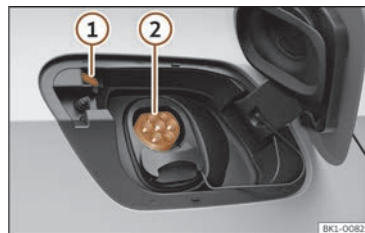
Fig. 56 Dietro il coperchio di ricarica della batteria nella parte posteriore destra: Presa di carica.
