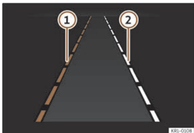
Fig. 124 Nella schermata del quadro strumenti: indicazioni del sistema di assistenza per il mantenimento della corsia.
