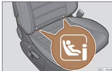
Fig. 37 Sedile passeggero anteriore: posizione degli occhielli di fissaggio del sistema i-Size.
