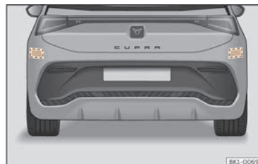
Fig. 112 Veduta posteriore del veicolo: zone dei sensori radar.
