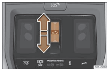
Fig. 101 Nel rivestimento interno del tetto: tasto di funzione per gestire la tendina parasole.
