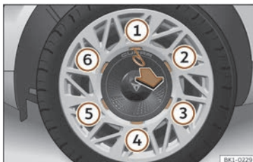
Fig. 192 Cambio ruota: rimozione del copricerchio centrale.
