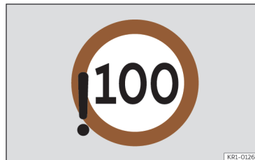
Fig. 8 Sul display del quadro strumenti: superamento della velocità massima ammissa (illustrazione).
