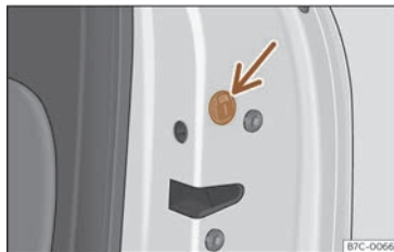
Fig. 76 Blocco di emergenza della porta.
