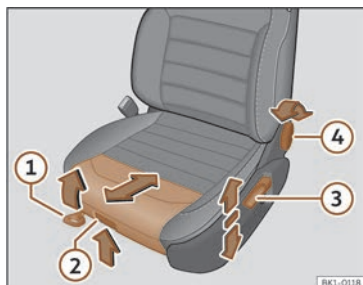
Fig. 84 Sedili anteriori: regolazione manuale del sedile.
