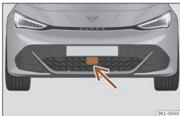
Fig. 109 Sul paraurti anteriore: sensore radar.
