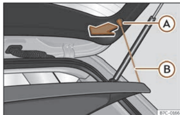
Fig. 161 Nel bagagliaio: smontare e montare il ripiano.
