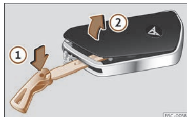
Fig. 69 Chiave del veicolo: aprire il coperchio del vano della batteria.
