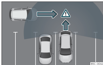
Fig. 164 Rappresentazione schematica dell'assistente di uscita dal parcheggio: zona vigilata attorno al veicolo che sta uscendo dal parcheggio.
