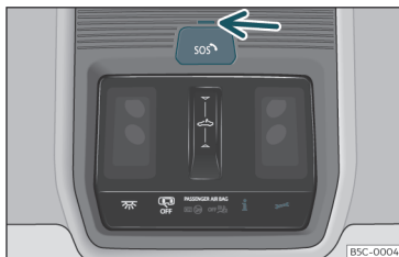
Fig. 32 Nella console del tetto: comandi per i servizi vocali
