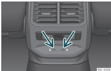
Fig. 133 Parte posteriore della console centrale: Connettori USB con funzione di presa di corrente.
