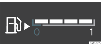
Fig. 55 indicatore del livello del carburante situato in posizioni diverse a seconda della visualizzazione.
