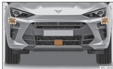
Fig. 123 Sul paraurti anteriore: sensori radar frontali e laterali.
