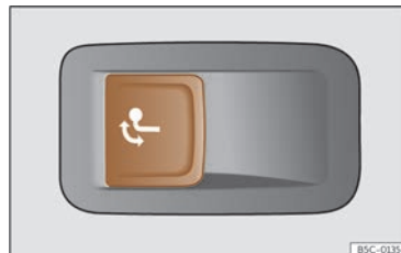
Fig. 196 Sul lato sinistro del bagagliaio: tasto per sbloccare il gancio di traino.
