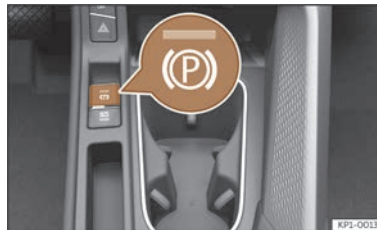
Fig. 147 Nella parte inferiore della console centrale: tasto del freno di stazionamento elettronico.
