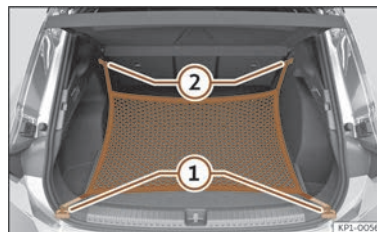
Fig. 191 Nel bagagliaio: occhielli ① e ganci ② per agganciare la borsa di rete.
