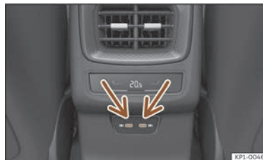
Fig. 174 Parte posteriore della console centrale: connettori USB con funzione di presa di corrente.
