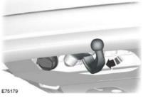
Portare il braccio della sfera di traino in posizione di funzionamento. Il braccio della sfera di traino si blocca in posizione di funzionamento. Il bloccaggio si sente chiaramente e il segnale acustico si arresta.
