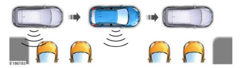
Quando il sistema trova un posto adatto, visualizza un messaggio ed emette un segnale acustico. A questo punto fermare il veicolo e attenersi alle istruzioni sullo schermo. Se il veicolo si sta muovendo molto lentamente, potrebbe essere necessario avanzare per un breve tratto prima che il sistema sia pronto per eseguire il parcheggio.
