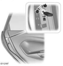
Le serrature di sicurezza per bambini sono poste nel bordo posteriore di ciascuna portiera posteriore e devono essere armate separatamente per ciascuna portiera.
