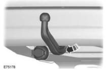
4. Ruotare manualmente il braccio della sfera di traino in modo continuo dalla posizione intermedia fino all'arresto nella posizione di normale funzionamento. Il braccio della sfera di traino si blocca automaticamente in posizione finale. Il processo di bloccaggio è percepibile acusticamente in modo chiaro solo se
