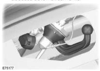
Portare il braccio della sfera di traino fino all'arresto in posizione di stivaggio. Il braccio della sfera di traino si blocca in posizione di stivaggio. Il bloccaggio si sente chiaramente e il segnale acustico si arresta.
