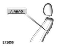
Gli airbag sono montati all'interno degli schienali dei sedili anteriori. Un'apposita etichetta applicata sul lato dello schienale del sedile indica la presenza dell'airbag.
