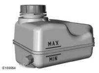
Assicurarsi che il livello del liquido di raffreddamento sia compreso tra i contrassegni MIN e MAX presenti sul serbatoio del liquido di raffreddamento. Se il livello del liquido di raffreddamento si trova in corrispondenza o al di sotto del contrassegno minimo, rabboccare immediatamente con liquido di raffreddamento.
