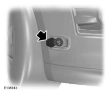
La presa del riscaldatore blocco motore si trova nel paraurti anteriore. Aprire lo sportello circolare a battente e assicurarsi, prima dell'uso, di controllare che i terminali di collegamento siano puliti e asciutti.
