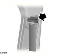
Per regolare l'altezza della cintura a bandoliera, premere il pulsante e far scorrere il regolatore di altezza verso l'alto o il basso. Rilasciare il pulsante e tirare verso il basso sul regolatore di altezza per controllare che sia bloccato.
