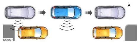
**Nota:** Se non si usano gli indicatori di direzione, il sistema si imposta automaticamente sul lato passeggero del veicolo.
