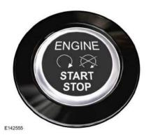
Premere una volta l'interruttore dell'accensione a pulsante, senza azionare il pedale del freno o della frizione. Tale interruttore è situato sul cruscotto, vicino al volante. Tutti i circuiti elettrici e ausiliari sono operativi e le spie e gli indicatori si illuminano.
