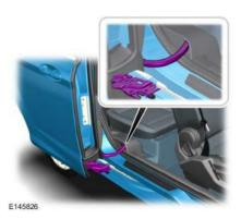
Ouando le portiere posteriori sono completamente aperte, fare attenzione a non calpestare il cavo o il meccanismo alla base del vano porta.
