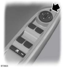
Con l'accensione inserita, è possibile utilizzare la funzione di ripiegamento elettrico dei retrovisori. Premere il comando per ripiegare o aprire i retrovisori.
