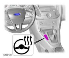
Premere il tasto per attivare il sistema. Il LED sull'interruttore si illumina quando il sistema è attivo.
