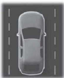
Quando si accende il sistema, sul display informazioni viene visualizzato il grafico aereo (vista dall'alto) di un veicolo con le linee di demarcazioni della corsia. Se si seleziona la modalità Avviso quando si accende il sistema, compare anche un'icona bianca separata o su alcuni veicoli compaiono delle frecce con le linee di demarcazione della corsia.
