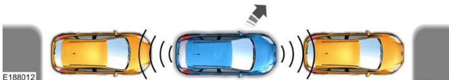
Il sistema determina lo spazio sulla parte anteriore e posteriore del veicolo e sterza automaticamente il veicolo per farlo uscire dal posto di parcheggio parallelo (senza mani) mentre l'utente controlla l'acceleratore, il cambio di marce e i freni. Il sistema fornisce istruzioni visive e acustiche all'utente per l'immissione nella circolazione stradale.
