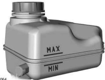
Assicurarsi che il livello del liquido di raffreddamento sia compreso tra i contrassegni MIN e MAX presenti sul serbatoio del liquido di raffreddamento. Se il livello si trova sul o al di sotto del contrassegno MIN o il serbatoio è vuoto, rabboccare immediatamente con liquido di raffreddamento. Vedere **Specifiche tecniche** (pagina 307).
