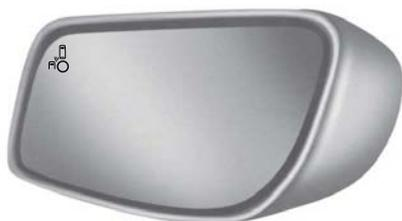
Quando il sistema rileva un veicolo, si accende una spia nello specchietto retrovisore esterno sul lato dal quale proviene il veicolo stesso. Se si attiva l'indicatore di direzione su quel lato del veicolo, la spia lampeggia.
