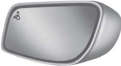
Quando il sistema rileva un veicolo, si accende una spia nello specchio retrovisore esterno sul lato dal quale proviene il veicolo. Viene anche emesso un segnale acustico e sul display informazioni compare un messaggio.
