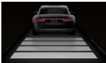
La distanza selezionata viene visualizzata nel display del quadro strumenti, come illustrato dalle barre nell'immagine.
