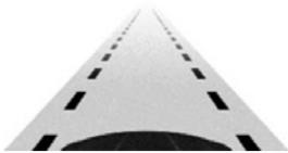
**Nota:** Il sistema funziona quando la telecamera è in grado di rilevare almeno una linea di demarcazione della corsia o il margine della carreggiata.
