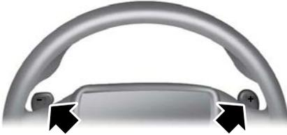
Tirare una delle due levette per attivare la funzione.
