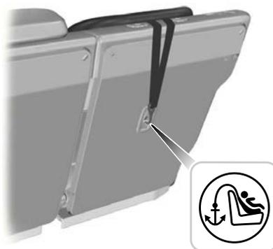
I punti di ancoraggio Top Tether si trovano sul retro del sedile posteriore.
