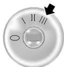
2. Portare la chiave in posizione III finché il motore non si avvia.
