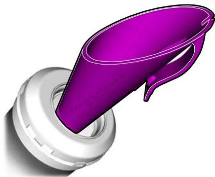
2. Inserire completamente l'imbuto nel bocchettone di rifornimento.
