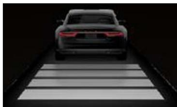
L'immagine veicolo si illumina se viene rilevato un veicolo che precede.
