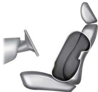
Gli airbag laterali sono progettati per gonfiarsi tra il pannello portiera e l'occupante del veicolo al fine di aumentare la protezione in determinati tipi di incidente.
