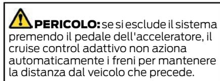
Premendo il pedale dell'acceleratore, è possibile escludere la velocità e la distanza impostate.
