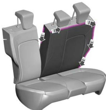
4. Posizionare il rivestimento del sedile sullo schienale del sedile.
