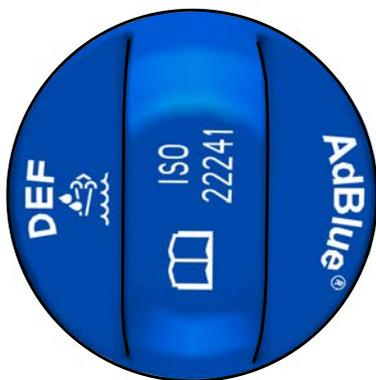
Il bocchettone di rifornimento dell'AdBlue® si trova accanto a quello del carburante e ha un tappo di colore blu. Riempire il serbatoio dell'AdBlue® utilizzando l'apposita pompa presso una stazione di servizio oppure versando l'AdBlue® da una tanica.
