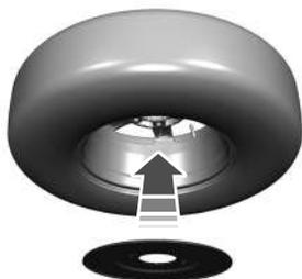
1. Se sul veicolo è presente una protezione del cavo del verricello, allineare le clip di inserimento sulla protezione del cavo del verricello ai fori dei dadi ruota, quindi spingere la piastra metallica fino a quando non è completamente fissata sul lato posteriore della ruota.
