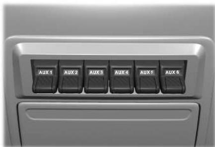
**Nota:** Se il veicolo è dotato di un motore diesel, utilizzare gli interruttori ausiliari solo se la chiave di accensione è in posizione On. L'utilizzo degli interruttori ausiliari, anche per brevi periodi di tempo, può causare il rapido esaurimento della batteria e la conseguente mancata accensione del veicolo.
