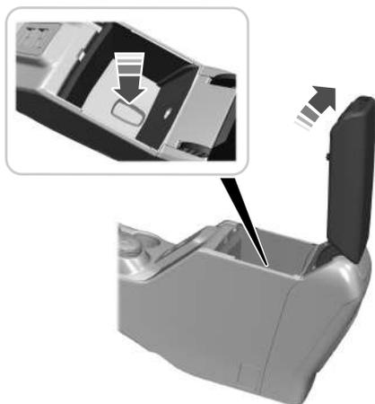
1. Posizionare il primo telecomando programmato nello slot di backup all'interno della console centrale. Con il piede staccato dal pedale del freno, premere e rilasciare il pulsante del commutatore di avviamento.
