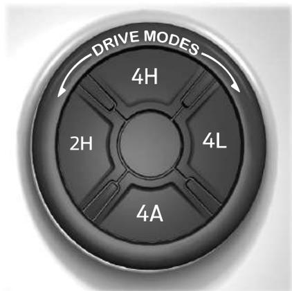
Ruotare il comando modalità di guida sulla console centrale per selezionare o cambiare la modalità di guida.
