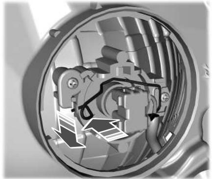
11. Per montare la lampadina, invertire le fasi di smontaggio.
