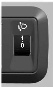
1. Ruotare il comando in base al carico del veicolo in modo da evitare di disturbare gli altri utenti della strada quando i fari sono accesi.
