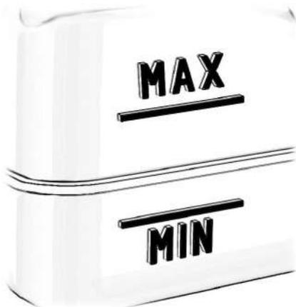
2. Osservare il serbatoio liquido freni per vedere dove si trova il livello dei liquido freni in relazione ai contrassegni **MIN** e **MAX**.
