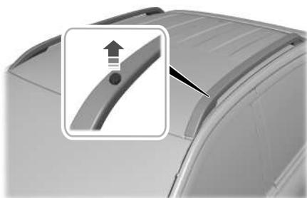
1. Rimuovere i coperchi bulloni del portapacchi inserendo contemporaneamente due strumenti sottili per la rimozione del rivestimento.
