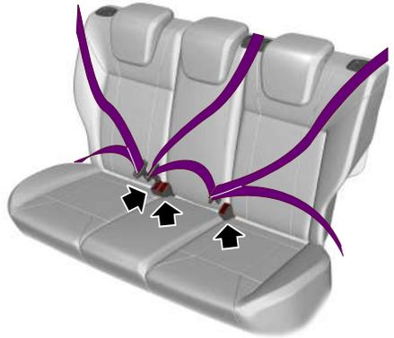
La cintura di sicurezza centrale della seconda fila può bloccarsi se si riporta con forza lo schienale del sedile dalla posizione ripiegata alla posizione verticale. Se la cintura di sicurezza si blocca, reclinare il sedile regolando l'inclinazione.
