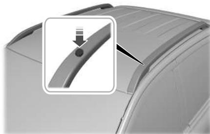
12. Montare i bulloni M8 Torx in dotazione con una chiave Torx T40. Serrare i bulloni a una coppia di 16 Nm.
