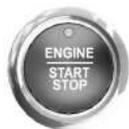
1. Premere e mantenere premuto l'interruttore dell'accensione a pulsante finché il motore si arresta oppure premerlo tre volte entro due secondi.
