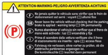
**!** Prima di uscire dal veicolo, controllare che il freno di stazionamento sia inserito: le relative spie sul quadro strumenti e sul comando devono essere accese fisse. Se il freno di stazionamento non è inserito, questo è indicato da un segnale acustico e da un messaggio visualizzato all'apertura della porta del guidatore.
