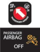
! Prima di installare un seggiolino per bambini con schienale opposto al senso di marcia, disattivare l'airbag del passeggero anteriore. Altrimenti, **il bambino rischia lesioni gravi o mortali in caso di attivazione dell'airbag.**
