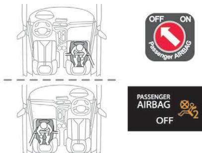
Quando un seggiolino per bambini con "schienale rivolto verso la strada" è collocato **sul sedile del passeggero anteriore**, occorre regolare il sedile del veicolo nella posizione più sollevata possibile e di massimo arretramento, con lo schienale in posizione verticale.
