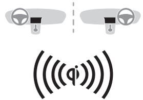
Questo sistema permette la ricarica senza fili di apparecchi portatili, ad esempio uno smart phone, utilizzando il principio dell'induzione magnetica, secondo la norma Qi 1.1. L'apparecchio da ricaricare deve essere compatibile con la norma Qi, per sua concezione o con l'ausilio di una custodia o di una scocca compatibile. La zona di carica è segnalata dal simbolo Qi.
