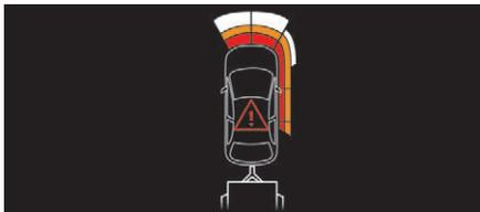
i Il funzionamento dei sensori di parcheggio posteriori verrà disattivato automaticamente in caso di traino di un rimorchio o di montaggio di un portabiciclette sul gancio traino installato secondo le raccomandazioni del costruttore. In questo caso, nella parte posteriore dell'immagine del veicolo verrà visualizzato il profilo di un rimorchio.
