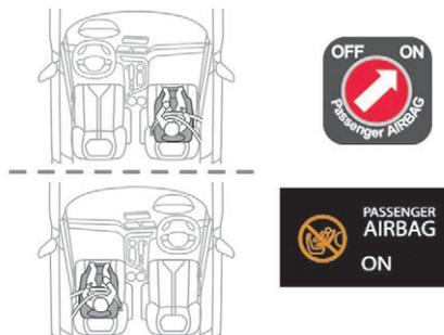
Quando un seggiolino per bambini è posizionato "nel senso di marcia" sul **sedile del passeggero anteriore**, regolare il sedile del veicolo in posizione longitudinale arretrata al massimo, posizione più alta, schienale raddrizzato. Lasciare l'airbag del passeggero anteriore attivato.
