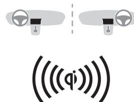
Consente la ricarica senza filo di dispositivi mobili, ad esempio uno smartphone, utilizzando il principio di induzione magnetica, secondo la norma Qi 1.1.
