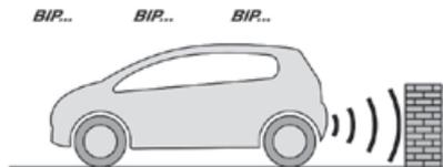
Questo sistema segnala la presenza di ostacoli all'interno della zona di rilevamento dei sensori e sulla traiettoria del veicolo definita dalla direzione del volante.
