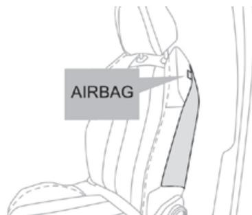
In caso di urto laterale grave, questo sistema protegge il guidatore e il passeggero anteriore per ridurre il rischio di lesioni al torace tra l'anca e la spalla.
