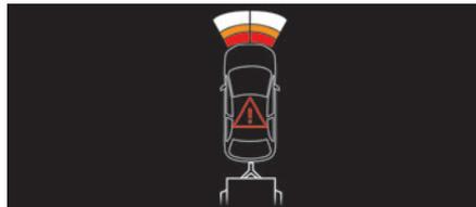
i Il sistema dei sensori di assistenza al parcheggio posteriori si disattiva automaticamente se un rimorchio o un portabicicletta è agganciato ad un dispositivo di traino installato secondo le raccomandazioni del Costruttore. In questo caso, il profilo di un rimorchio viene visualizzato nella parte posteriore dell'immagine del veicolo.
