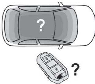
Quando la chiave elettronica non viene rilevata o non si trova più nella zona di riconoscimento, sul quadro strumenti viene visualizzato un messaggio alla chiusura di una porta o alla richiesta di spegnimento del motore.
