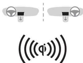
Questo sistema consente la ricarica senza filo di dispositivi mobili, ad esempio smartphone, utilizzando il principio di induzione magnetica, secondo la norma Qi 1.1.
