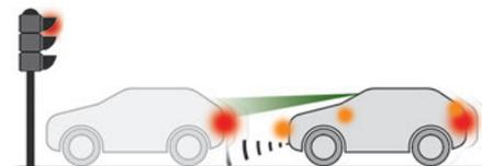
Questa funzione, chiamata anche "frenata automatica d'emergenza", interviene dopo l'avviso acustico se il guidatore non aziona abbastanza velocemente il pedale del freno.
