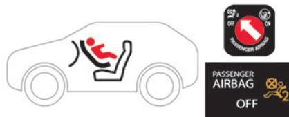
**!** Prima di installare un seggiolino per bambini di tipo "spalle verso la strada", disattivare l'airbag anteriore lato passeggero. Altrimenti, **il bambino rischia lesioni gravi o mortali in caso di attivazione dell'airbag**.
