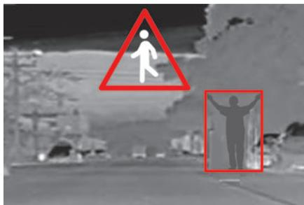
La gamma di rilevamento della telecamera è compresa tra 15 m (per i pedoni) e 200 m, secondo le condizioni di visibilità.
