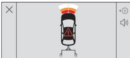
**i** Il sistema dei sensori di assistenza al parcheggio posteriori si disattiva automaticamente se un rimorchio o un portabicicletta è agganciato ad un dispositivo di traino installato secondo le raccomandazioni del Costruttore. In questo caso, il profilo di un rimorchio viene visualizzato nella parte posteriore dell'immagine del veicolo.
