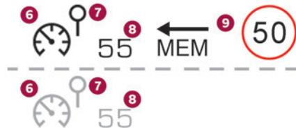
6. Indicazione di funzionamento/pausa del limitatore di velocità
