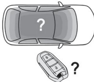
Quando la chiave elettronica non viene rilevata o non si trova più nella zona di riconoscimento, sul quadro strumenti viene visualizzato un messaggio
