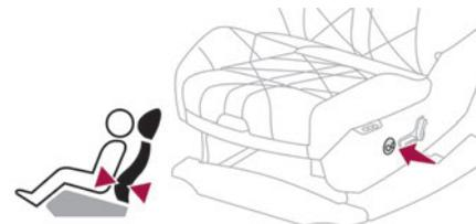
Il comando permette di regolare separatamente la profondità e la posizione verticale del sostegno lombare.
