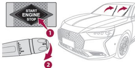
Azionando il comando del tergicristallo subito dopo l'interruzione del contatto, è possibile posizionare le spazzole del tergicristallo in posizione verticale.
