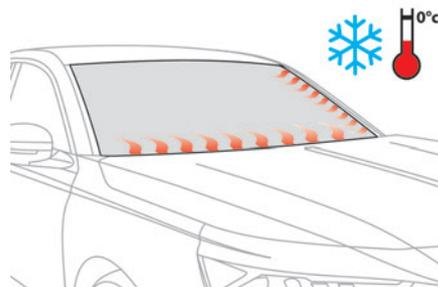
In presenza di clima freddo, questo sistema riscalda la base del parabrezza e la zona situata lungo il montante sinistro dello stesso.
