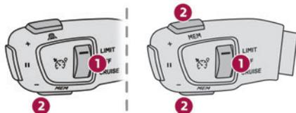
1. Selezione della modalità limitatore di velocità/regolatore di velocità
