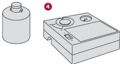
4. Compressore da 12 V con flacone di prodotto sigillante ed etichetta autoadesiva del limite di velocità.
