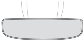
Il sistema fotocromatico utilizza un sensore che rileva il livello di luminosità esterna e la luminosità proveniente dalla parte posteriore del veicolo, per passare automaticamente e progressivamente da utilizzo diurno a notturno.
