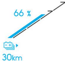
Il livello di carica della batteria di trazione e l'autonomia rimanente nella modalità di guida
