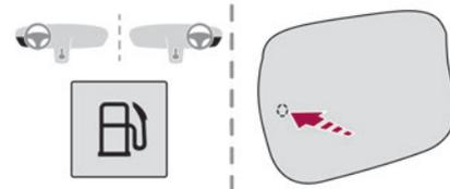
► Per aprire lo sportellino del serbatoio, premere il pulsante di apertura dello sportellino per più di 2 secondi o, con le porte del veicolo sbloccate, premere la parte posteriore dello sportellino (secondo la versione).
