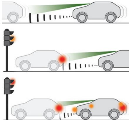
Questa funzione, chiamata anche "frenata automatica d'emergenza", interviene dopo l'avviso acustico se il guidatore non aziona abbastanza velocemente il pedale del freno. Questo sistema ha l'obiettivo di ridurre la velocità d'impatto o di evitare un urto del veicolo in caso di mancato intervento da parte del guidatore.
