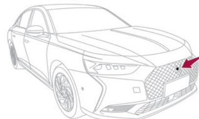
Questo sistema identifica e segnala la presenza di pedoni e animali nel campo visivo del guidatore, in condizioni di visibilità esterna ridotta, utilizzando una telecamera a infrarossi situata nella parte anteriore del veicolo.
