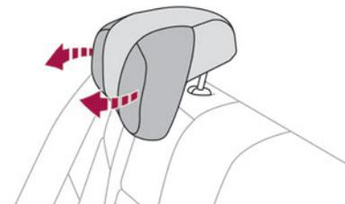
Secondo la versione, è possibile ripiegare i lati degli appoggiatesta per un confort ottimale.
