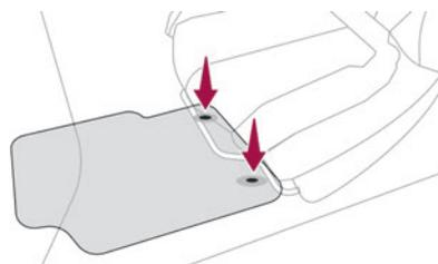
Per la collocazione sul lato del guidatore, utilizzare solo i fissaggi presenti sul tappetino (un "clic" indica il bloccaggio corretto).
