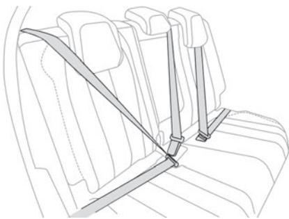
Ogni sedile posteriore è dotato di cintura di sicurezza a tre punti con avvolgitore.
