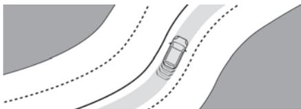
Il sistema identifica i bordi della corsia e sterza il veicolo per mantenerlo all'interno di questa corsia nella posizione laterale scelta dal guidatore.
