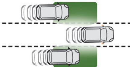
Questo sistema avverte il guidatore di un potenziale pericolo derivante della presenza di un altro veicolo (autovettura, autocarro, moto) negli angoli ciechi del veicolo (zone nascoste fuori dal campo visivo del guidatore), usando i sensori installati ai lati dei paraurti.
