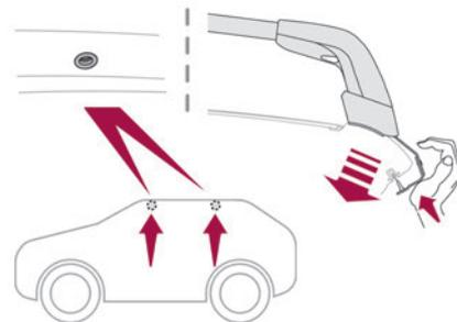
Le barre trasversali devono essere fissate esclusivamente ai quattro punti di ancoraggio sul telaio del tetto. Questi punti sono nascosti dalle porte del veicolo quando sono chiuse. Le barre del tetto sono dotate di un perno, che deve essere inserito nell'apertura di ogni punto di ancoraggio.
