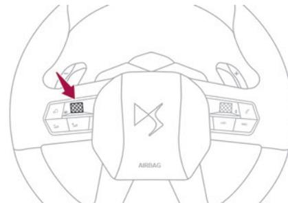
► Ruotare la ghiera sulla sinistra del volante per visualizzare e far scorrere le varie schermate sul quadro strumenti.
