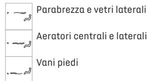
Viene attivato un simbolo per visualizzare la presenza di aria ventilata nella direzione indicata. È possibile attivare tutti e tre i pulsanti contemporaneamente, per una distribuzione uniforme in tutto l'abitacolo.
