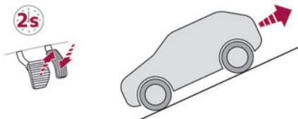
**Con la parte anteriore rivolta verso la discesa, a veicolo fermo e con la retromarcia inserita, il veicolo rimane immobilizzato per un istante quando il guidatore rilascia il pedale del freno.**
