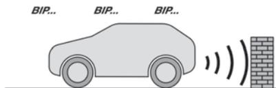
Questo sistema segnala la presenza di ostacoli all'interno della zona di rilevamento dei sensori e sulla traiettoria del veicolo definita dalla direzione del volante.
