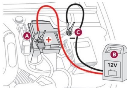
► Spegner il carica batterie **B** prima di collegare i cavi alla batteria, per evitare il rischio di scintille.
