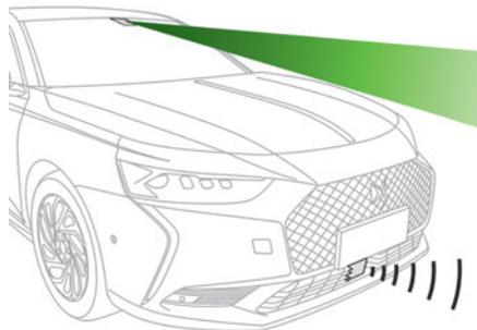
Il veicolo è dotato di una telecamera multifunzione sulla parte superiore del parabrezza e, secondo la versione, di un radar montato sul paraurti anteriore.
