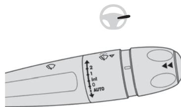
► Per selezionare la velocità di funzionamento: sollevare o abbassare il comando sulla posizione desiderata.
