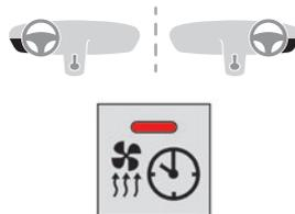
Questa spia si accende fissa quando è stato programmato un ciclo di pre-condizionamento della temperatura. Lampeggia quando il pre-condizionamento della temperatura è in corso.
