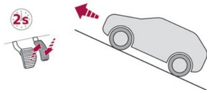
**Con la parte anteriore rivolta verso la salita, a veicolo fermo, quest'ultimo rimane immobilizzato per un istante quando il guidatore rilascia il pedale del freno:**
