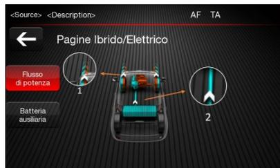
L'energia viene trasmessa dal motore a combustione interna (ICE) alle ruote e dalla batteria alle ruote, quando c'è maggiore richiesta di energia. Il flusso 1 mostra l'energia necessaria al movimento. Il flusso 2 mostra l'energia trasmessa dalla batteria alle ruote.
