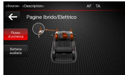
L'energia viene trasmessa dall'ICE alle ruote per fornire forza motrice. L'ICE si riferisce al motore a combustione interna che fornisce energia al veicolo. Il flusso 1 mostra l'energia necessaria al movimento.
