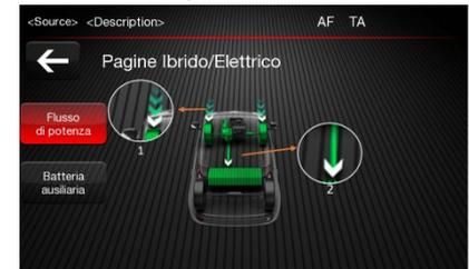
L'energia si trasmette dalle ruote alla batteria per ricaricarla durante le frenate o i movimenti per inerzia. Il flusso 1 mostra l'energia termica derivante dalla frenata delle ruote, il flusso 2 mostra l'energia che ritorna alla batteria ricaricandola. Premere il tasto ← per tornare al menù principale.
