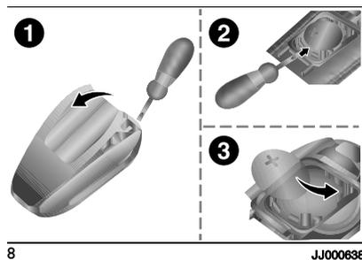
1. Rimuovere il coperchio posteriore inserendo un piccolo cacciavite nella fessura e sollevare il coperchio (fig. 7 per il radiocomando, fig. 8 per la chiave elettronica).
