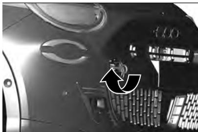
Avvitare l'occhiello di traino fino a battuta in posizione orizzontale fig. 288. Fissare la barra di traino al relativo occhiello.
