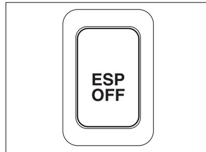
Quando si preme il selettore ESP® OFF posto al centro del cruscotto per disattivare i sistemi ESP® (non ABS), si accende la spia indicatore ESP® OFF nel quadro strumenti.
