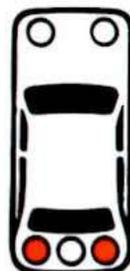
Avaria alle luci d'arresto: si accende il segnalatore posteriore del lato vettura interessato. Con una lampada bruciata o cablaggio interrotto, il segnalatore si accende solo a pedale freno premuto e circa due secondi dopo il suo azionamento.
