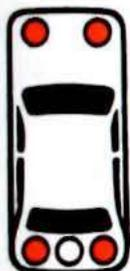
Avaria alle luci di posizione posteriori: con luci di posizione accese, si accende il segnalatore posteriore del lato vettura interessato (lampada bruciata o cablaggio interrotto).
