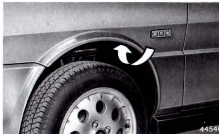
Sfilare dall'interno del parafrangente anteriore il portalampada fissato a pressione, dopo aver asportato la protezione del vano ruota e sostituire la lampada (4W).
