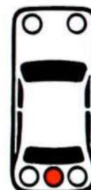
Avaria alle luci posteriori antinebbia: con luci posteriori antinebbia accese, viene segnalata la bruciatura di una o di entrambe le lampade o l'interruzione del cablaggio tra fusibile e lampada.
