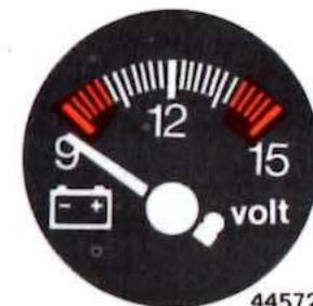
mente nella posizione corrispondente a  $14 \div 14,5$  V. I valori rilevati devono essere considerati tenendo conto di una tolleranza dello strumento di  $\pm 0,3$  V.
