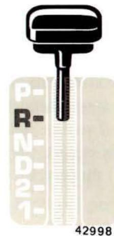
«N» corrisponde alla posizione di folle di un normale cambio meccanico a comando manuale. In «N» il cambio automatico non espleta nessuna funzione d'innesto.
