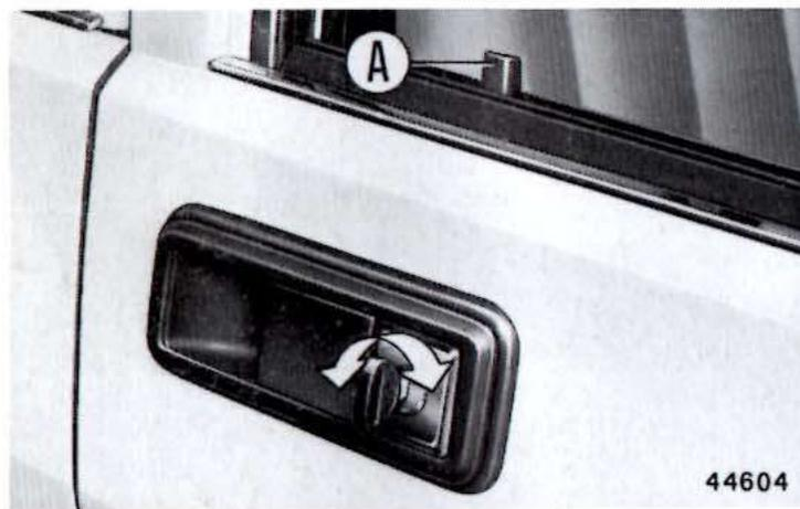
Bloccando una delle due porte laterali anteriori, dall'esterno con la chiave e dall'interno premendo il pomello A, si ottiene anche il blocco simultaneo dell'altra porta laterale anteriore e delle due porte laterali posteriori.
