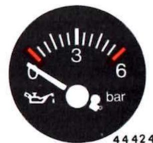
Con motore caldo, mediamente la pressione dell'olio oscilla tra 3,5 e 5 bar.
