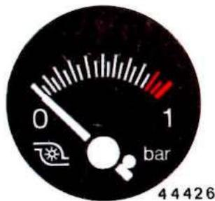
Qualora l'indicatore dovesse segnalare con continuità, valori di pressione superiori a 0,85 bar, rilasciare l'acceleratore per rientrare nel campo di funzionamento normale e successivamente rivolgersi alla Rete Assistenziale LANCIA.
