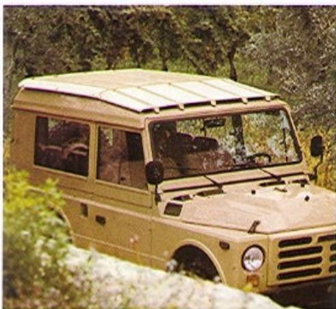
Doppio tetto per le versioni Hard Top, per migliorare la coibentazione interna attenuando gli effetti dell'irradiazione solare.
