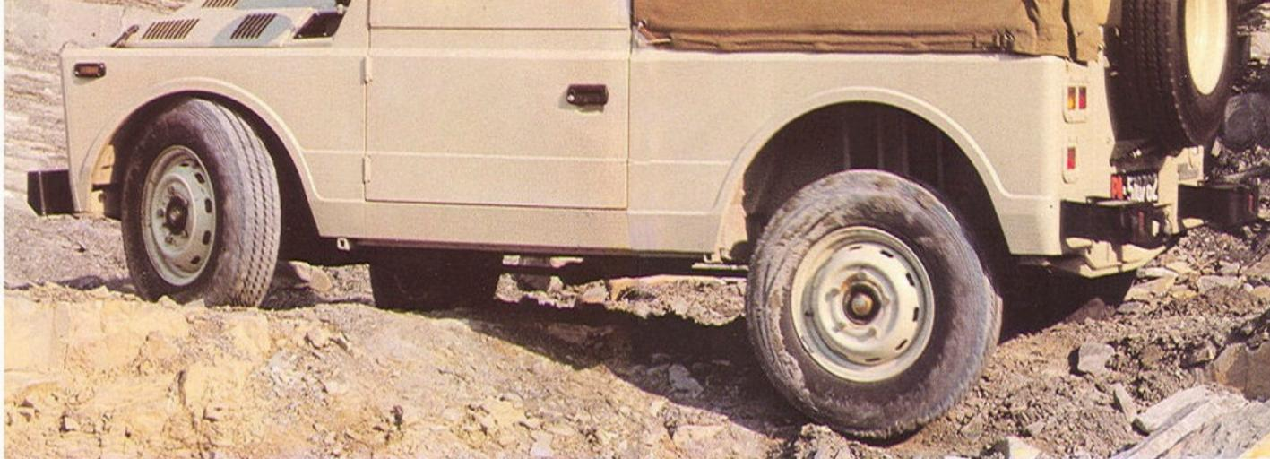
Scocca a struttura portante e sospensioni a 4 ruote indipendenti. Ogni ruota oscilla indipendentemente dalle altre. Ciascuna è collegata ad una barra di acciaio al cromo molibdeno la cui torsione, progressiva e dolce, è ulteriormente smorzata da ammortizzatori idraulici a doppio effetto. Ne risulta una sospensione particolarmente morbida.
