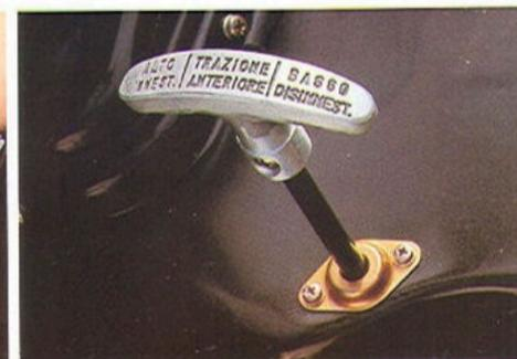
La trazione integrale si innesta agendo su questo comando a T che inserisce la trazione sulle ruote anteriori. L'inserimento, come il disinserimento, possono essere effettuati anche in marcia.
