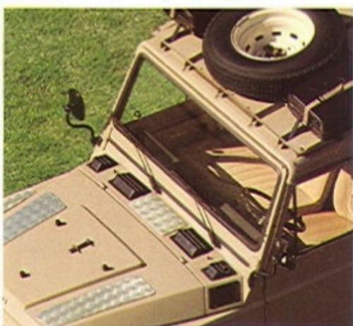
Supporto della ruota di scorta sul doppio tetto, portacanistri e pedane di salita su cofano motore.
