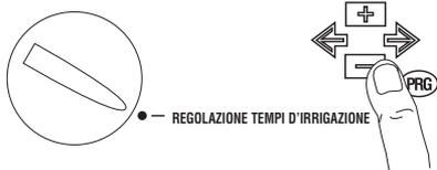
3. Rilasciare il tasto **+**. Il display mostrerà un tempo di attesa espresso in secondi applicabile a tutte le stazioni; l'indicazione è lampeggiante. Viene visualizzata anche l'indicazione "DELAY".
