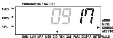
5. L'ora deve essere visualizzata sul display. Per selezionare AM, PM o 24 H (ORE ANTIMERIDIANE, ORE POMERIDIANE, 24 ORE) usare i tasti **+** e **-**. Premere il tasto **➔** per far scorrere le ore. L'ora deve lampeggiare. Per modificare l'ora visualizzata usare i tasti **+** e **-**. Premere il tasto **➔** per far scorrere i minuti. I minuti devono lampeggiare. Usare i tasti **+** e **-** per modificare i minuti visualizzati sul display. La data, il giorno e l'ora sono stati impostati.
