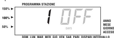
NOTA: Il calcolo dei giorni rimanenti senza irrigazione viene eseguito ogni giorno a mezzanotte. Quando si arriva a zero, viene visualizzata l'ora del giorno e alla prossima partenza programmata di ciclo ricomincia l'irrigazione normale.
