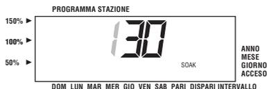
Azionando in qualsiasi momento il tasto **PRG** durante la regolazione del tempo del ciclo di irrigazione di una stazione si potrà programmare il tempo di infiltrazione della stazione in questione.
