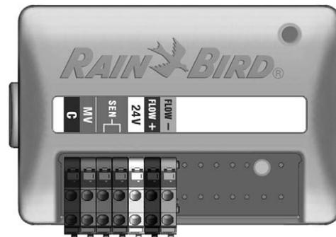
**! NOTA:** il modulo di base e il modulo Smart flusso sono dotati di un ponticello che collega i terminali del sensore clima (SEN). Non rimuovere il ponticello tranne nel caso in cui venga installato un sensore clima. Nel caso in cui non si installi un sensore clima, non rimuovere il ponticello. Per informazioni più dettagliate vedere Installazione, collegamento del sensore di clima locale, nella Sezione H.
